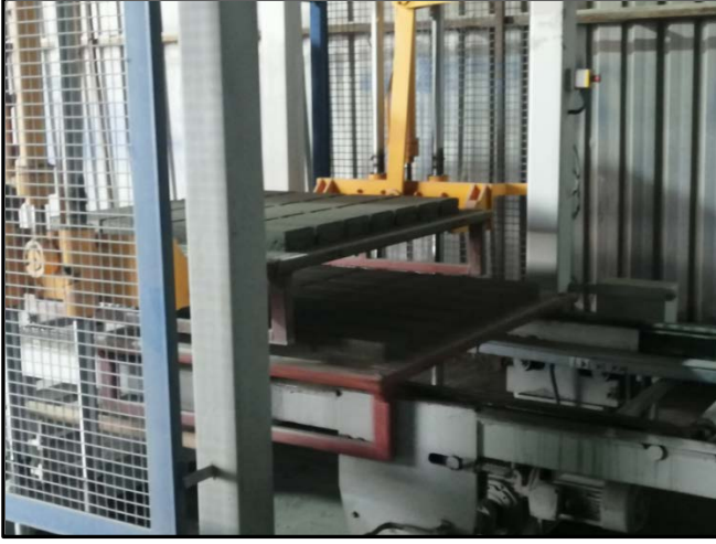
Şekil 8. Beton parke taş üretim bandı
