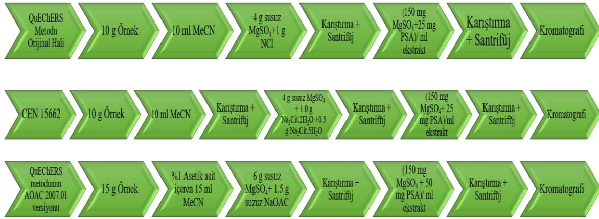
Şekil 5. QuEChERS metodu işlem akış şeması
