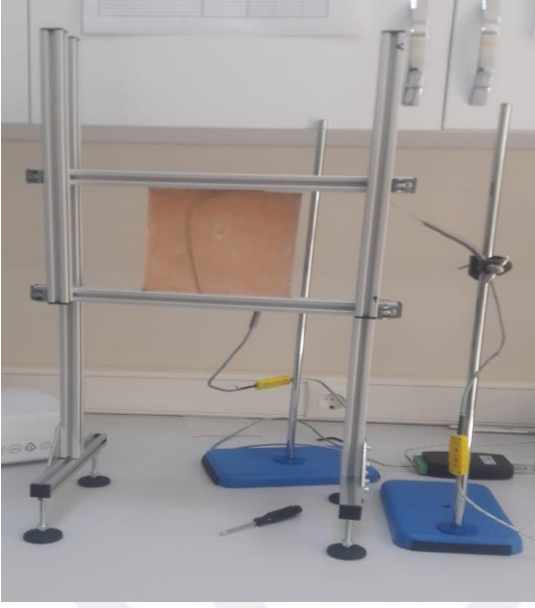
Şekil 9. Levha üzerindeki termokupl termometre
