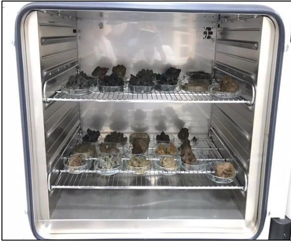
Şekil 9. Numunelerin etüve yerleştirilmesi ve 60°C'de 24 saat kurutma işlemi
