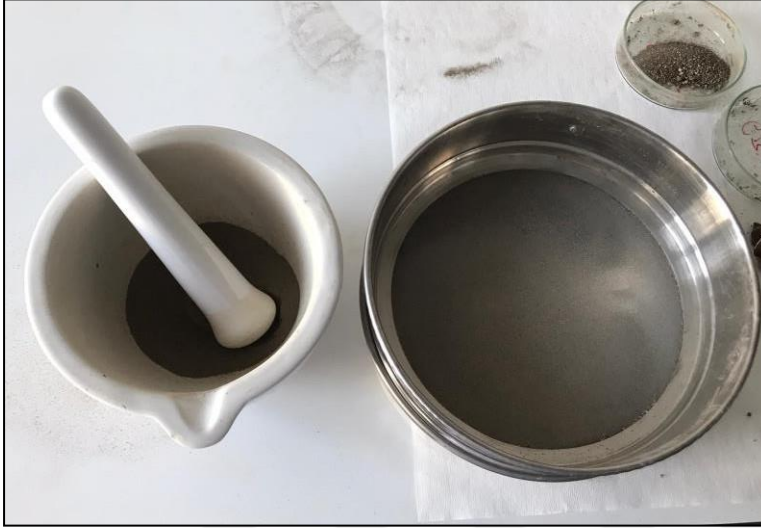
Şekil 10. Numuneleri havanda dövülerek inceltilmesi ve elekte elenmesi
