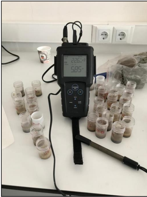
Şekil 7. Toprak ve sediment örneklerinin pH metre ile pH ölçümü
