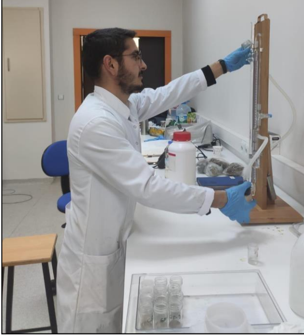
Şekil 8. Schibler kalsimetre aleti ile örneklerin \text{CaCO}_3 seviyelerinin ölçülmesi
