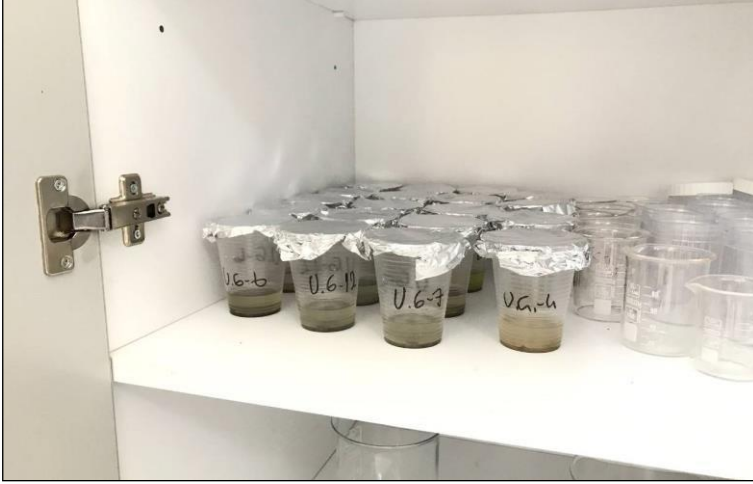
Şekil 15. Polietilen bardakların üzerleri kapatılarak bekleme alınması
