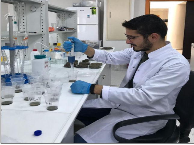
Şekil 14. Polietilen bardaklar içerisinde bulunan yaş sedimentler üzerine aseton dökülmesi
