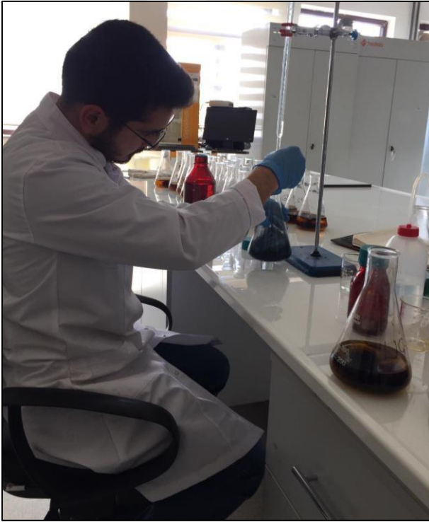
Şekil 13. Titrasyon işleminin yapılması
