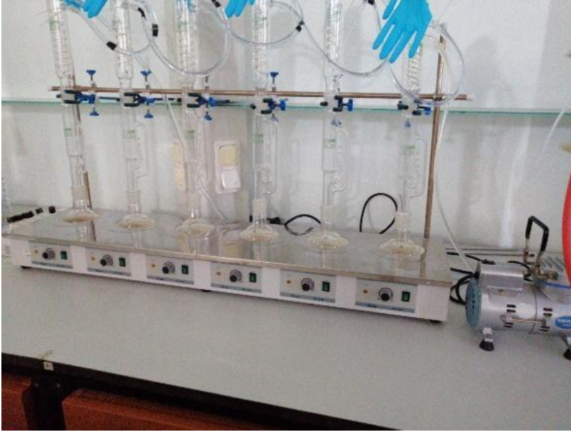
Şekil 9. Yağ ekstraksiyonu için kullanılan Soxhlet cihazı
