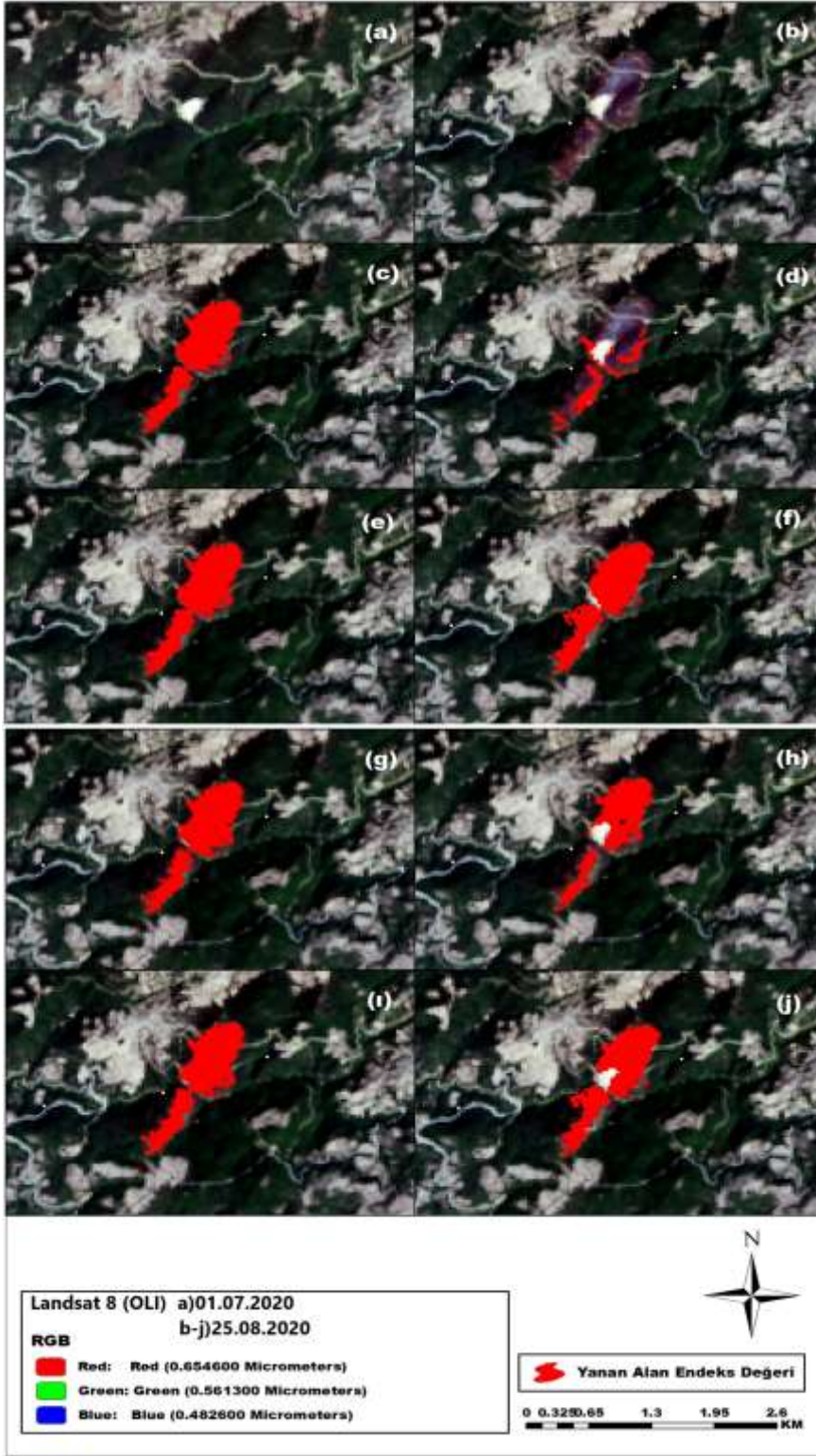
Şekil 62. Kızıldam 30 metre mekânsal çözünürlüklü yanan alan değerleri a)Yangın öncesi b)Yangın sonrası c)NDVI değeri d)EVI değeri e)SAVI değeri f)MSAVI değeri g)NBR değeri h)NBR2 değeri i)NDMI değeri j)GEMI değeri
