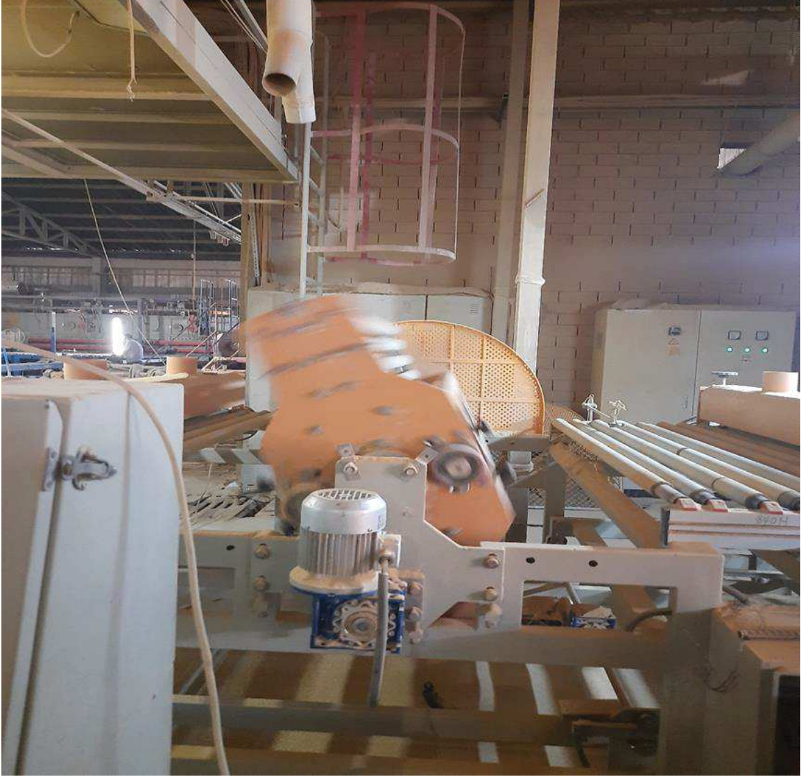
Şekil 13 Makine ile aksamın döner ve hareketli parçalarının erişime açık olması
