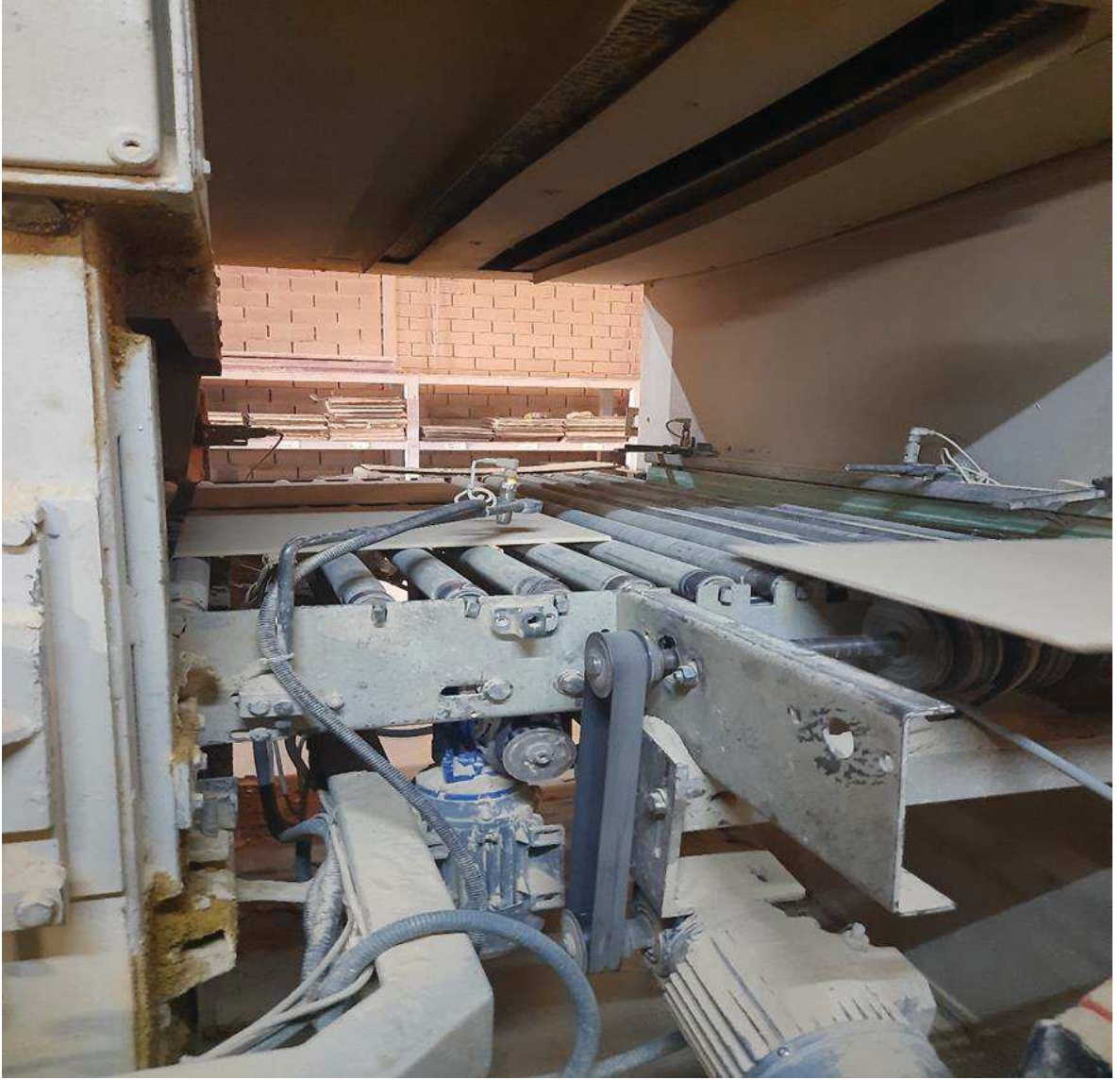
Şekil 17 Dönen ve hareketli aksamlardaki muhafazaların olmaması
