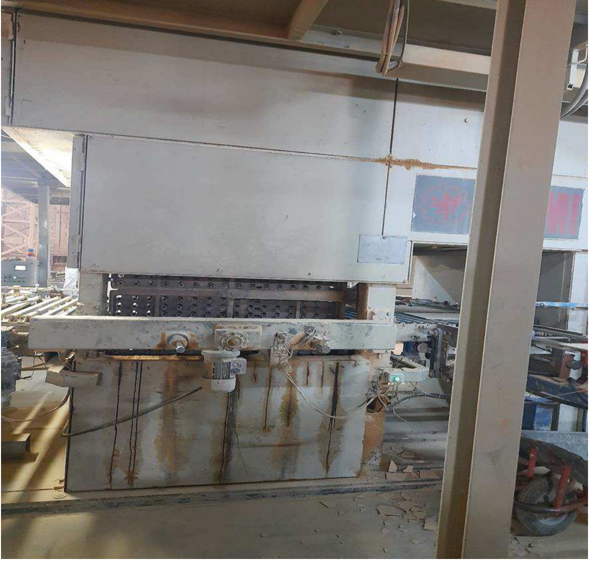
Şekil 19 Kurutucu mengil çukuru kapaklarının açık bırakılması
