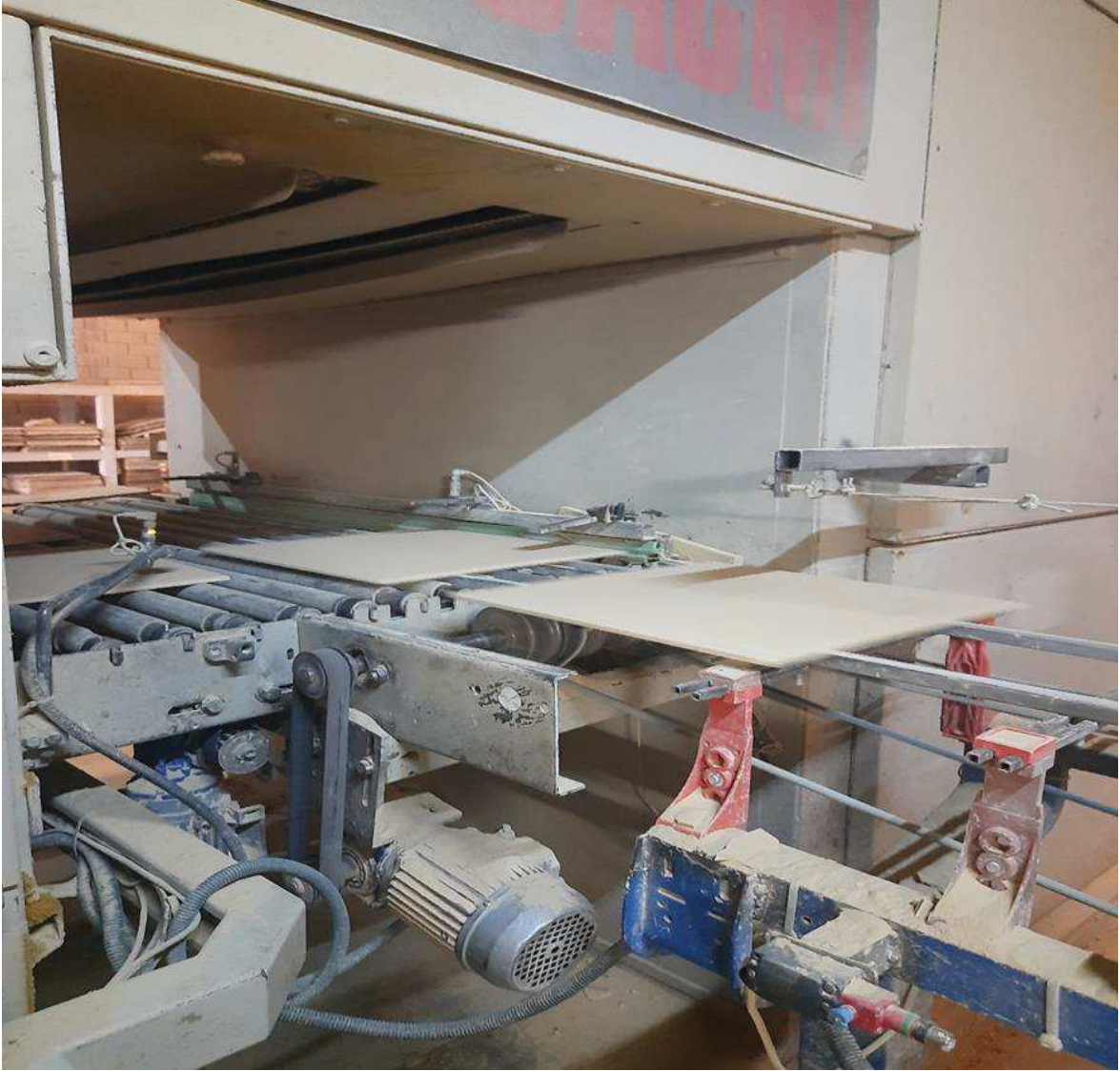
Şekil 18 Kurutucu acil durdurma telinin çalışır vaziyette olmaması
