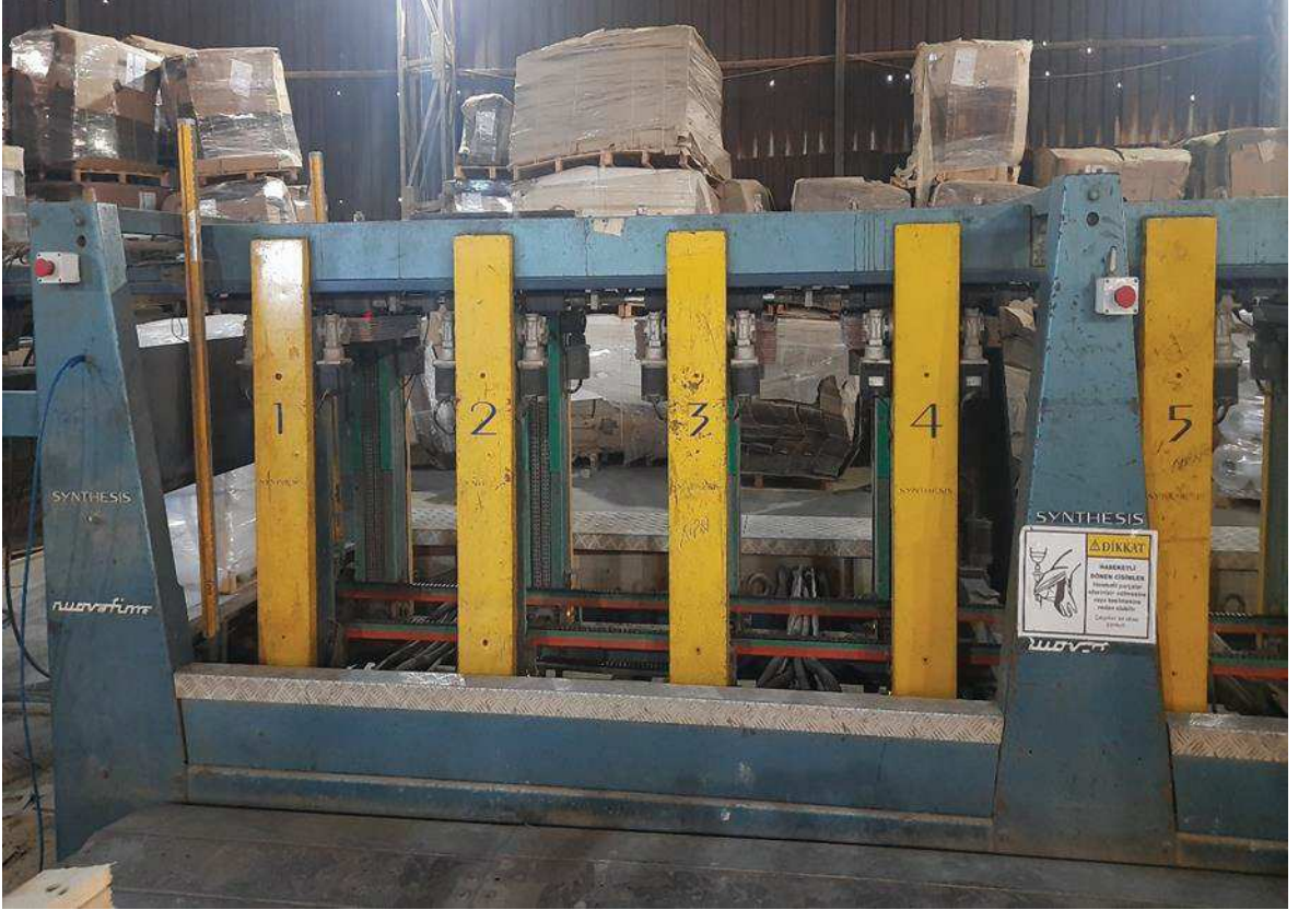
Şekil 30 Acil butonlarının, tellerin, sensörlerin, yan kapakların olmaması ve çalışmaması
