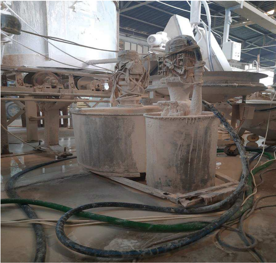
Şekil 23 Sır stok tankları bölgesinde bulunan hortum ve kablolarla takılma
