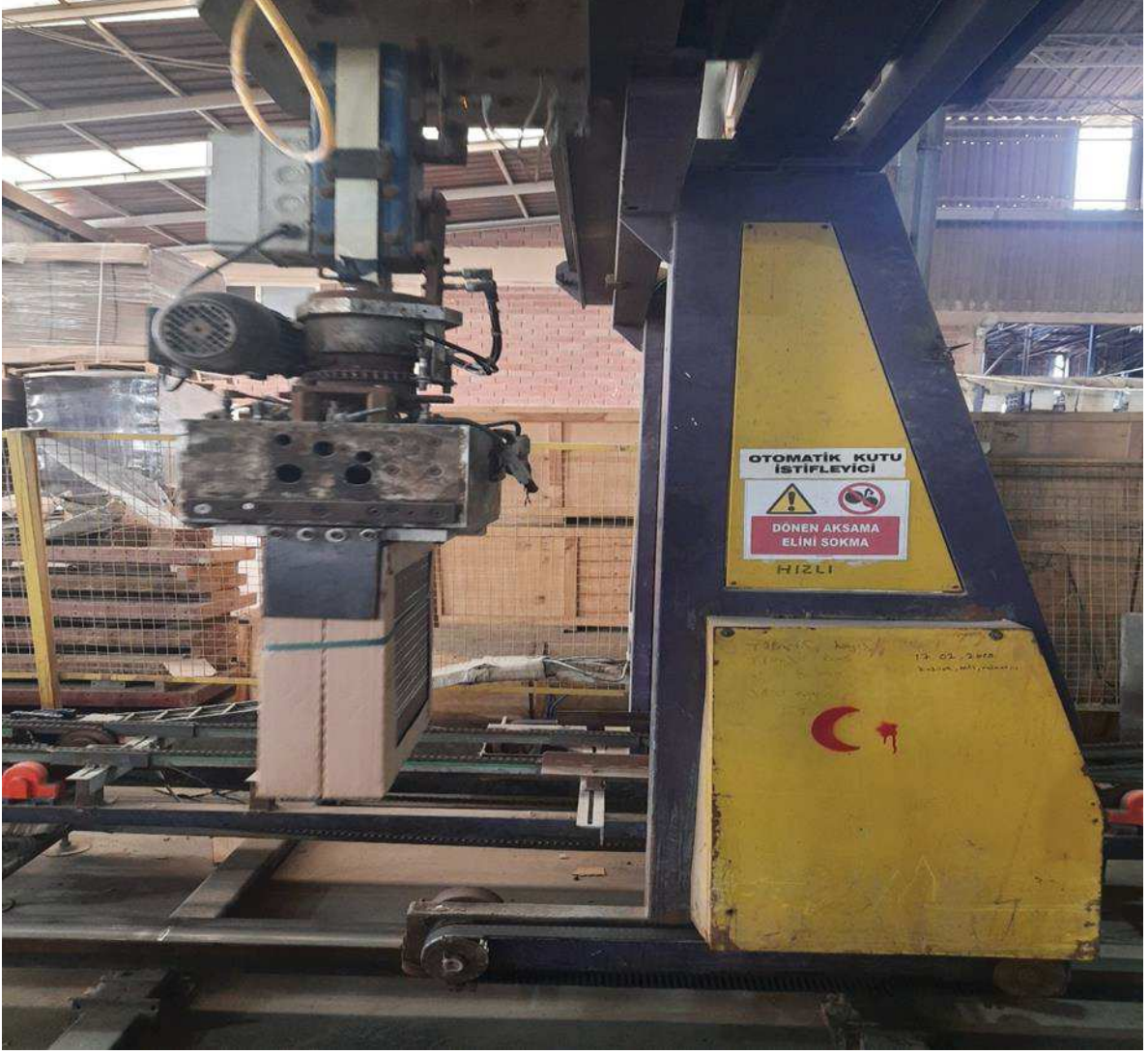
Şekil 31 Acil butonlarının, tellerinin, sensörlerin olmaması, çalışmaması
