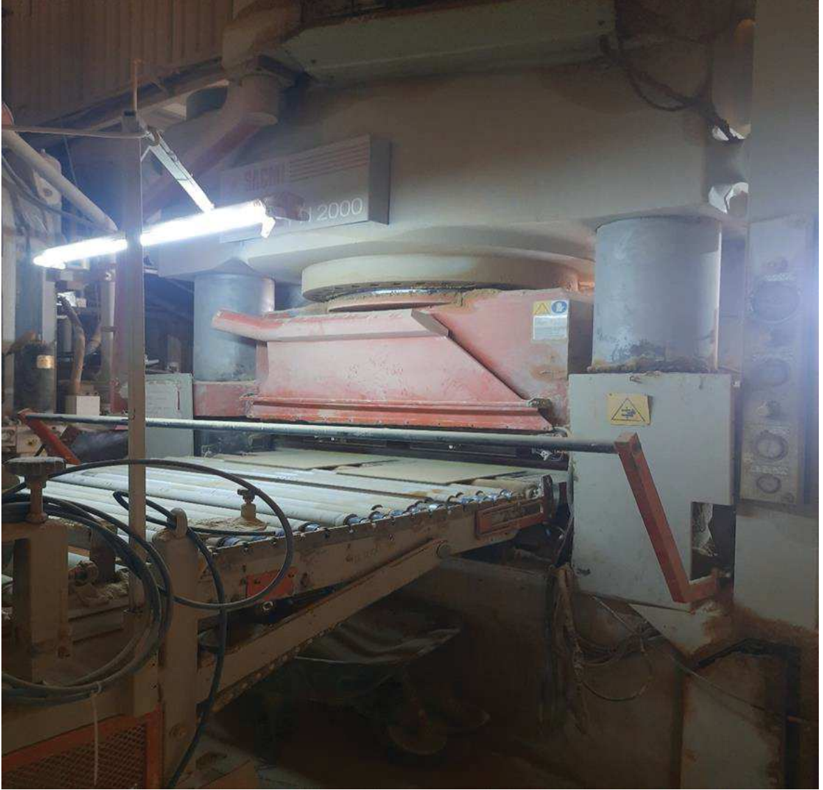
řekil 14 Preslerde řekillendirme iřleminin gerekleřtięi blgenin eriřime aık olması
