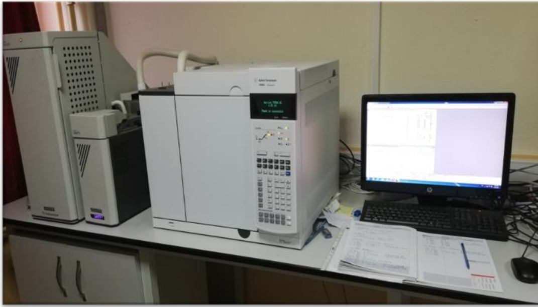
Şekil 13. Çalışmada kullanılan Termal Desorber/Gaz Kromatografi (TD-GC/FID) cihazları
