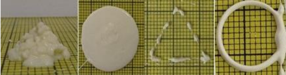
Şekil 7. Oda sıcaklığındaki KP-50 örneğinin oda sıcaklığındaki baskı yüzeyi üzerine yapılan üç boyutlu yazma işlemi denemeleri
