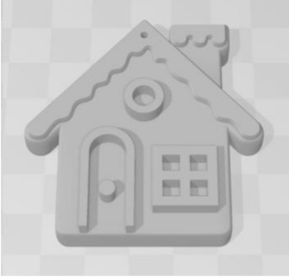
Şekil 4. Ev şekli (genişlik ve uzunluk 55,73 mm, en yüksek nokta 12 mm)
