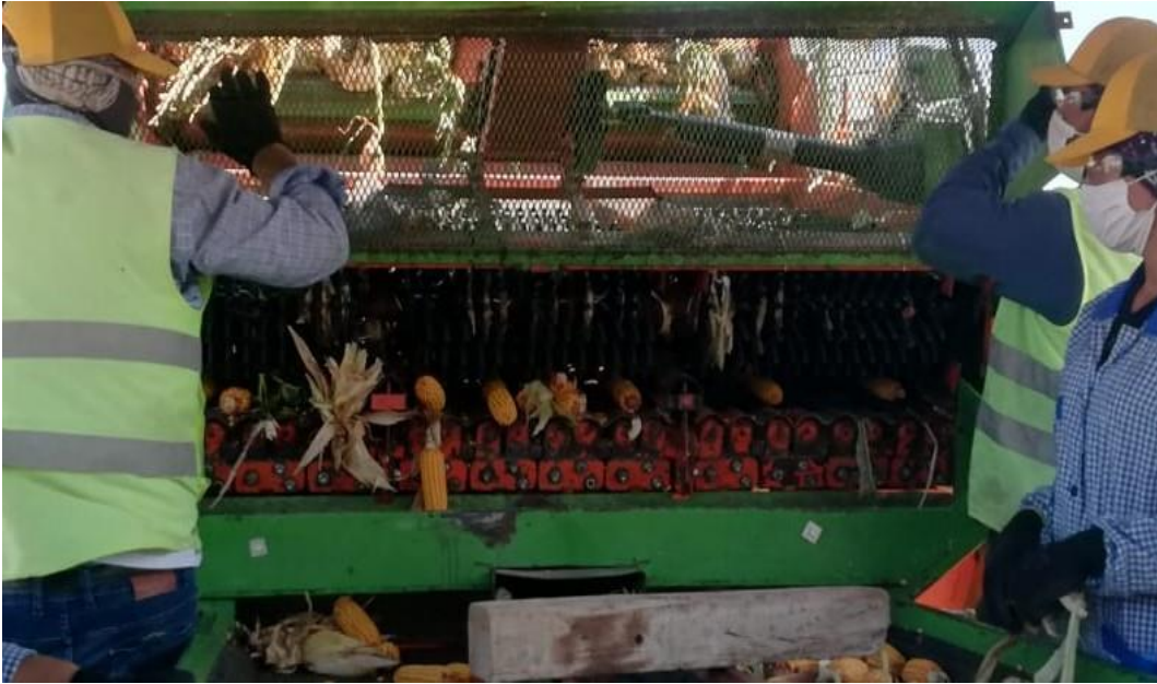
Şekil 14. Mısır soyma ünitesinin mekanizması
