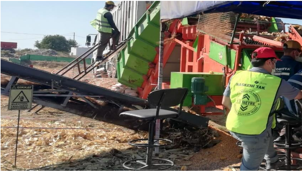
Şekil 17. Mısır atıkları, atık uzaklaştırma konveyörü ve makine operatörü
