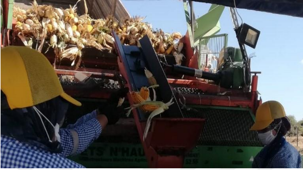
Şekil 16. Kovalı iletici ile soyulmamış mısır koçanlarının tekrar makineye iletilmesi
