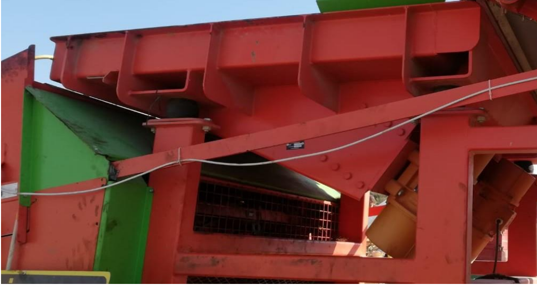
Şekil 11. Mısır koçanı soyma makinasına ait sarsak mekanizması.
