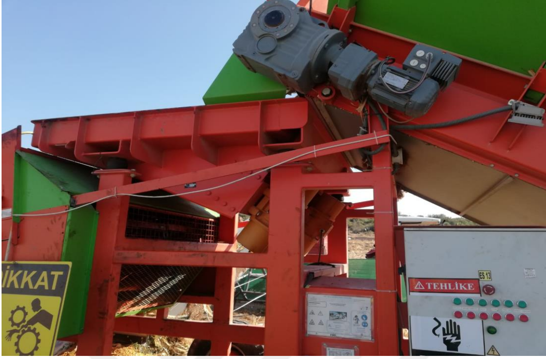
Sekil 10. Güç ve aktarma organları (elektrik motoru, varyatör, redüktör)
