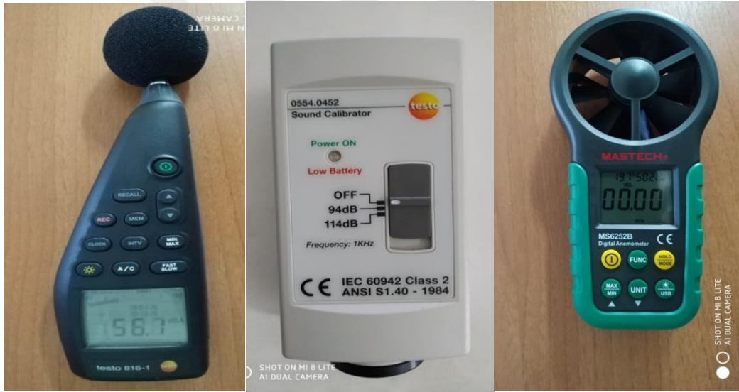
Şekil 19. Ölçüm cihazları, a) Ses basınç düzeyi ölçer, b) Kalibratör, c) Anemometre
