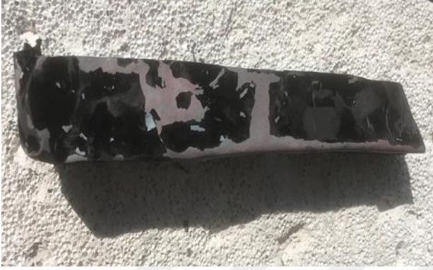
Şekil 30. Bronz folyonun fırın işlemi sonucu korozyon etkisi (Kişisel deneme)
