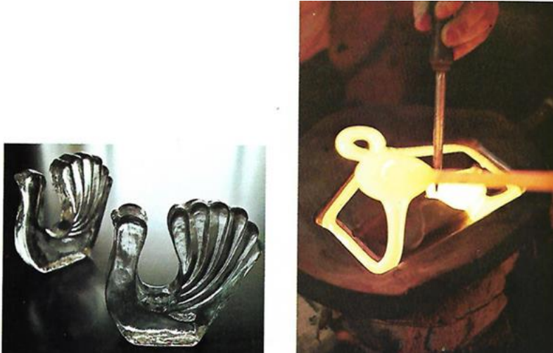
Şekil 28. Metal kalıba sıcak cam döküm tekniği (Küçükerman 1985)
