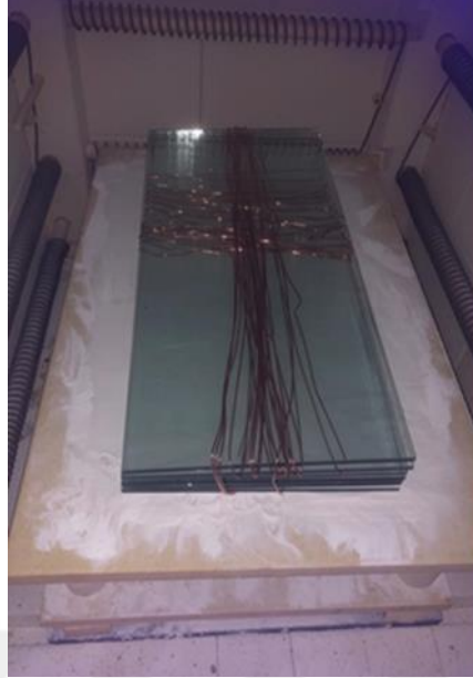
Şekil 94. Cam bloğun fırın içi düzenlemesi cam düzenlemesi
