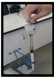
Şekil 3.4. EE'nin Sephadex LH-20 kolon dolgu maddesine uygulanması
