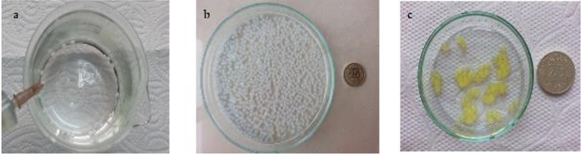
Şekil 4.1. a) Kitosan, b) Kitosan/FEA ve c) Kitosan/CIN boncuklarının elde edilmesi
