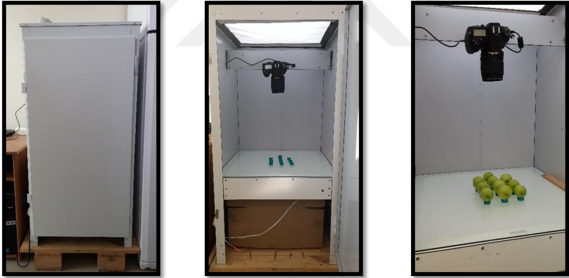
Şekil 3.2. Görüntü işleme düzeneğinin (LightBox) görüntüsü
