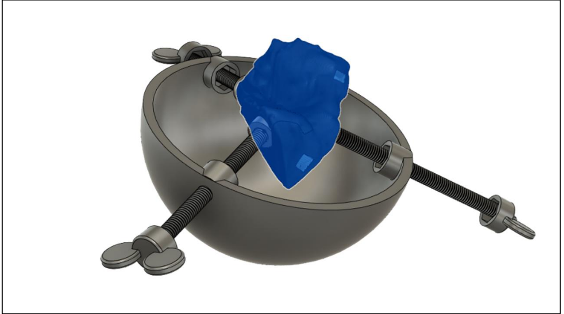
Şekil 3.10 M8 civata ile sabitlenmiş dura, temporal kemik tutucu ve civata başlıkları modeli
