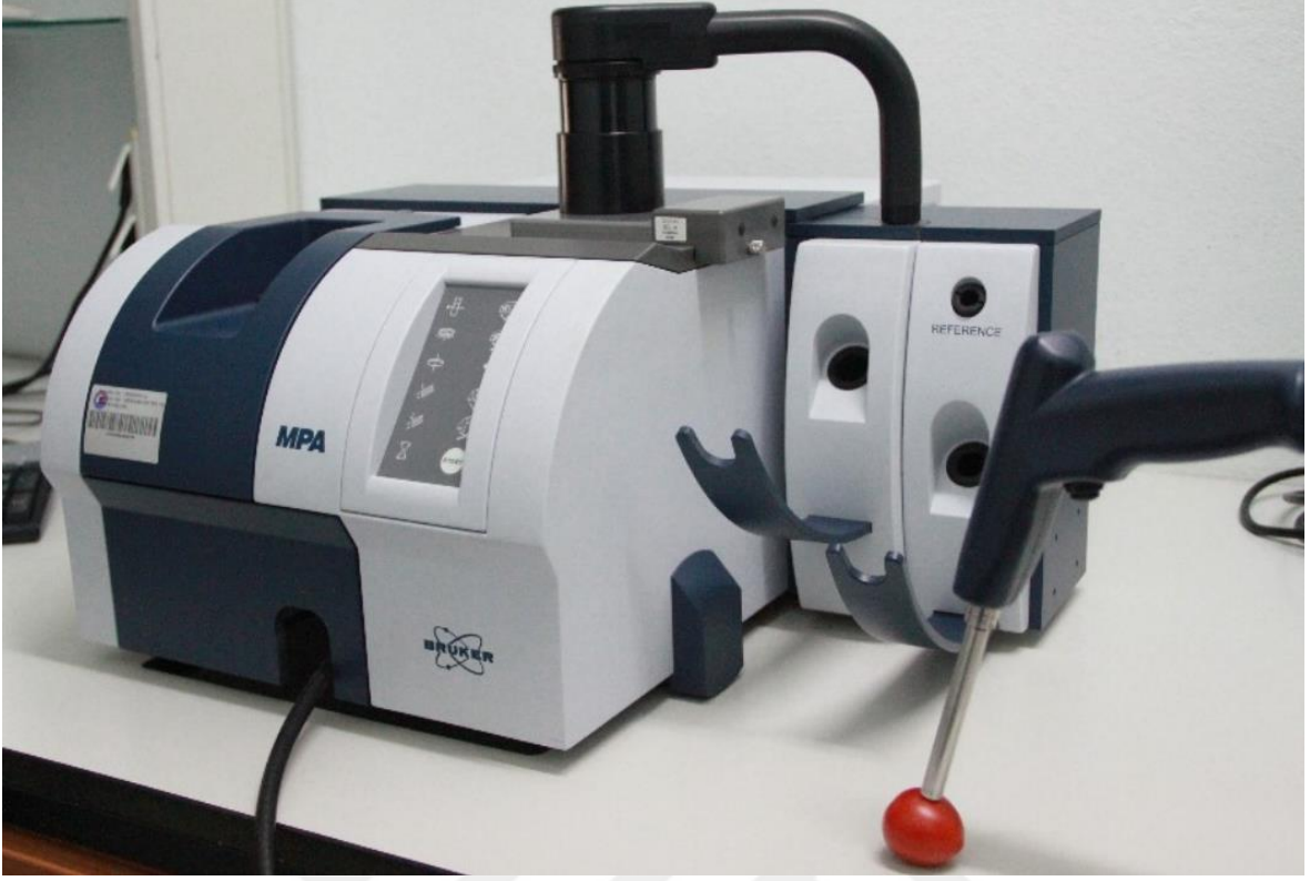
Şekil 11. Yansımada spektrum ölçümü; domates örneği ve üzerine tutulan prob (sağ alt)
