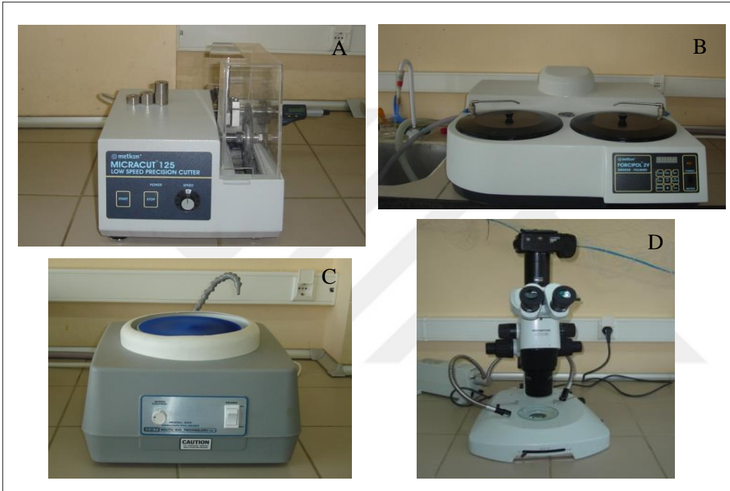
Şekil 9. Düşük devirli kesme (A), zımpara (B), parlatma (C) makinaları ve stereozoom mikroskop (D)
