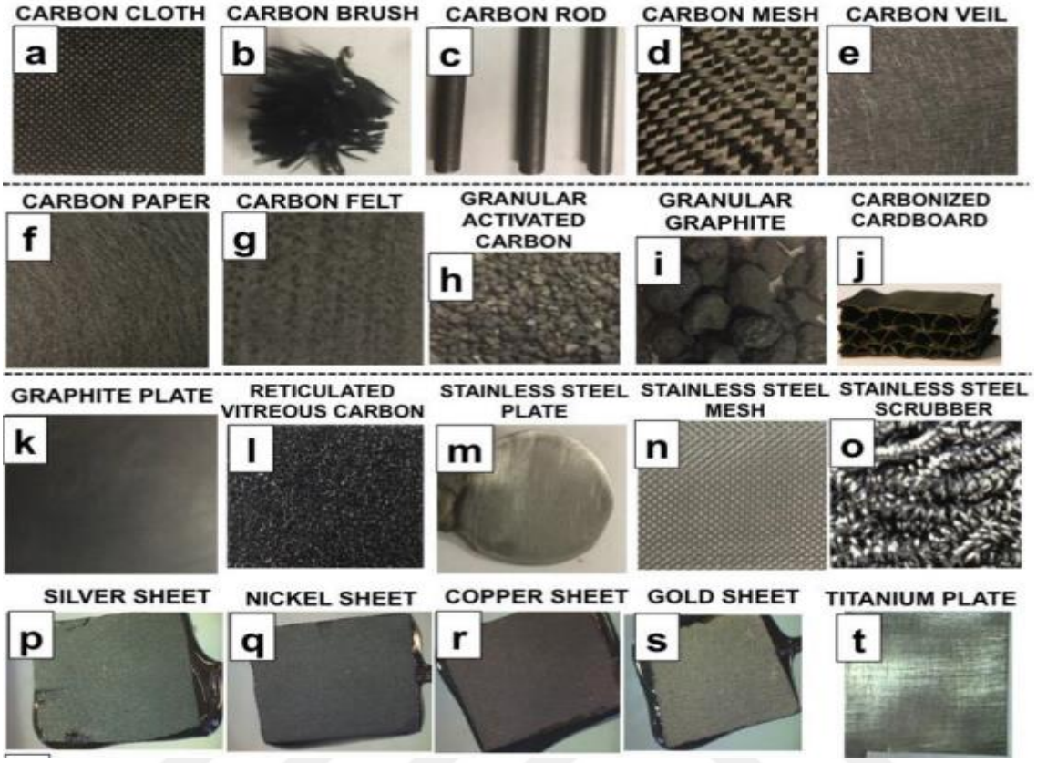
Şekil 2. MYP’lerde Anot Olarak Kullanılan Karbon Materyaller
