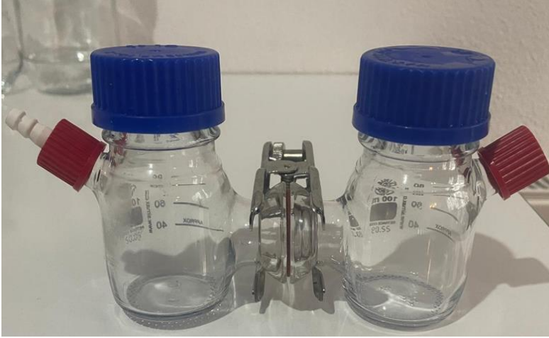
Şekil 12. 100 mL 'lik H tipi reaktör
