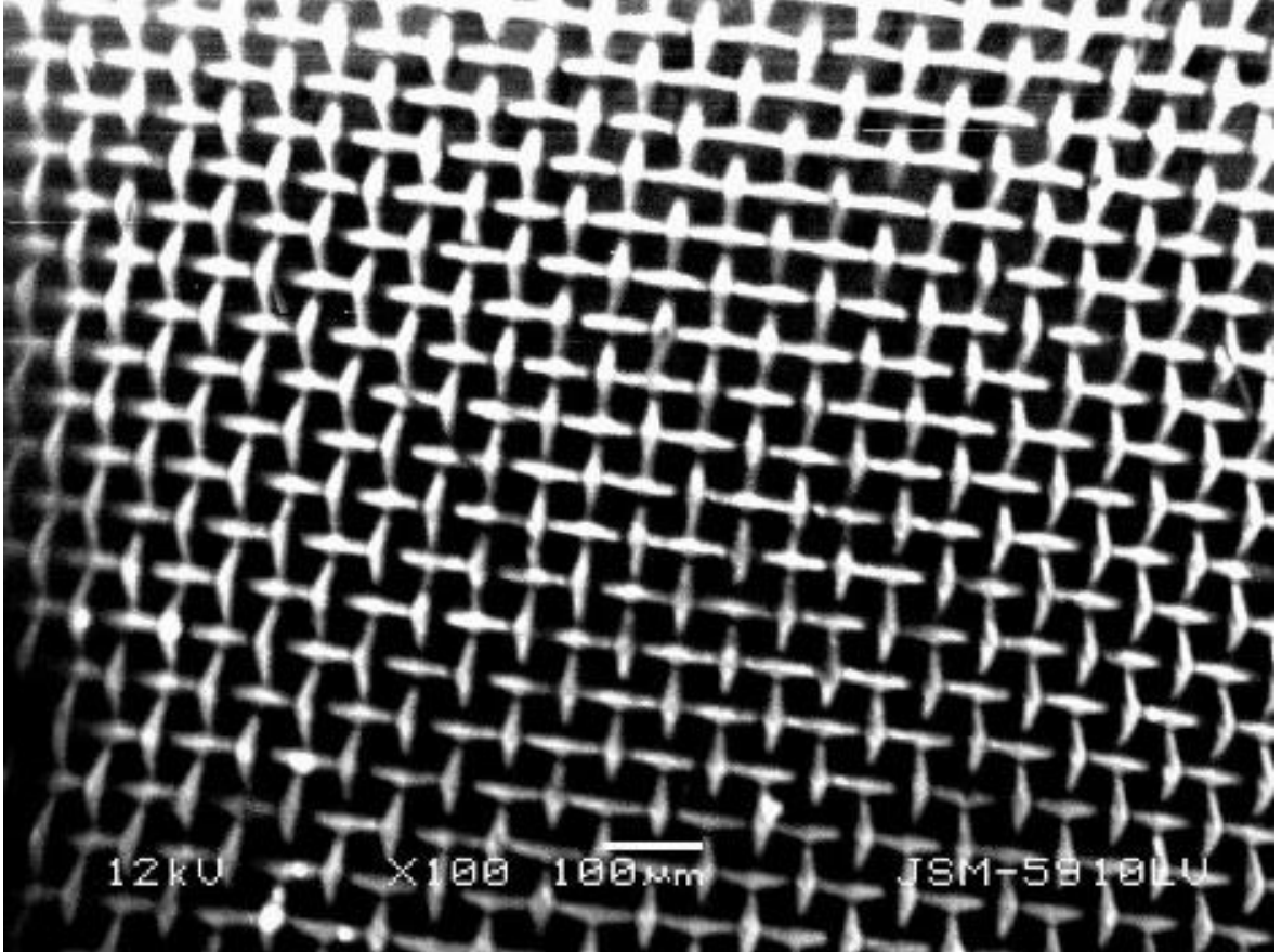
Şekil 10: Kullanılmamış arteriyel filtrenin 100X SEM görüntüsü
