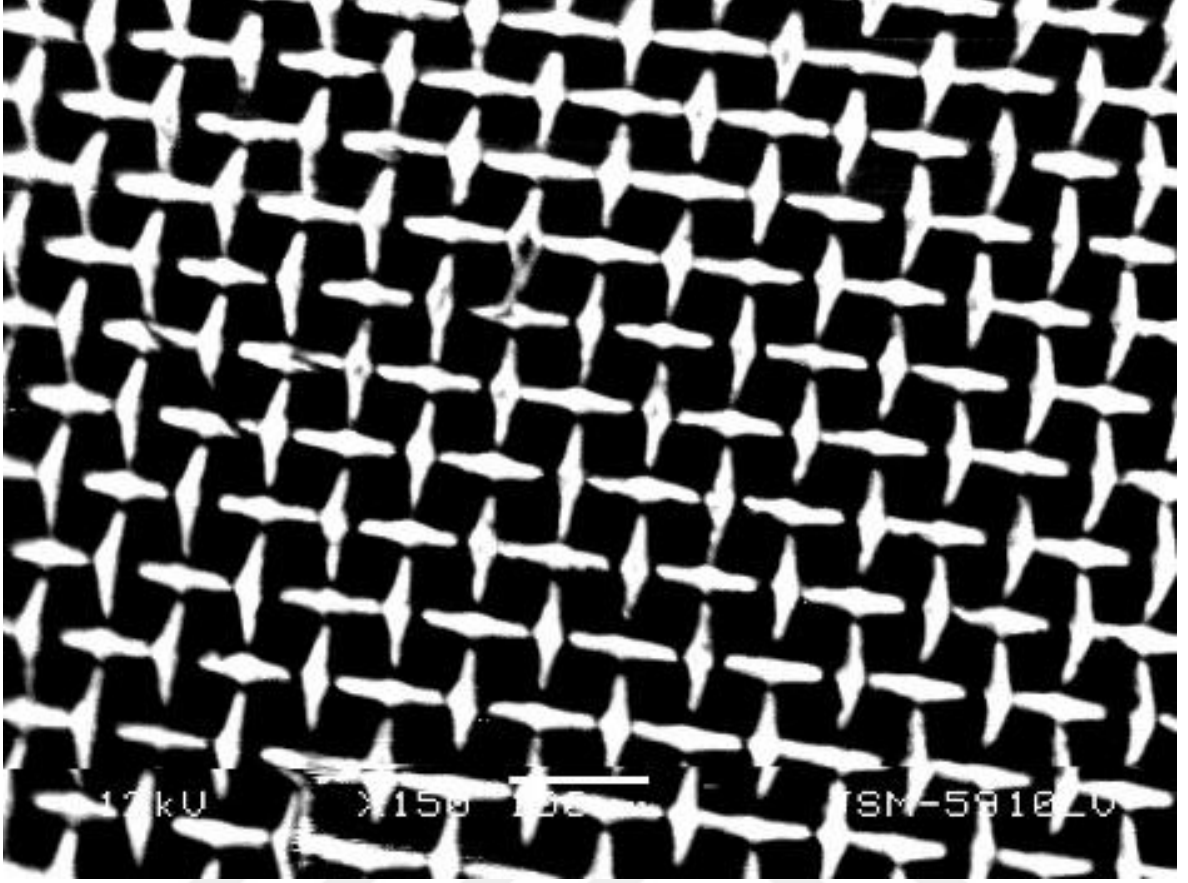
Şekil 11: Kullanılmamış arteriyel filtrenin 150X SEM görüntüsü
