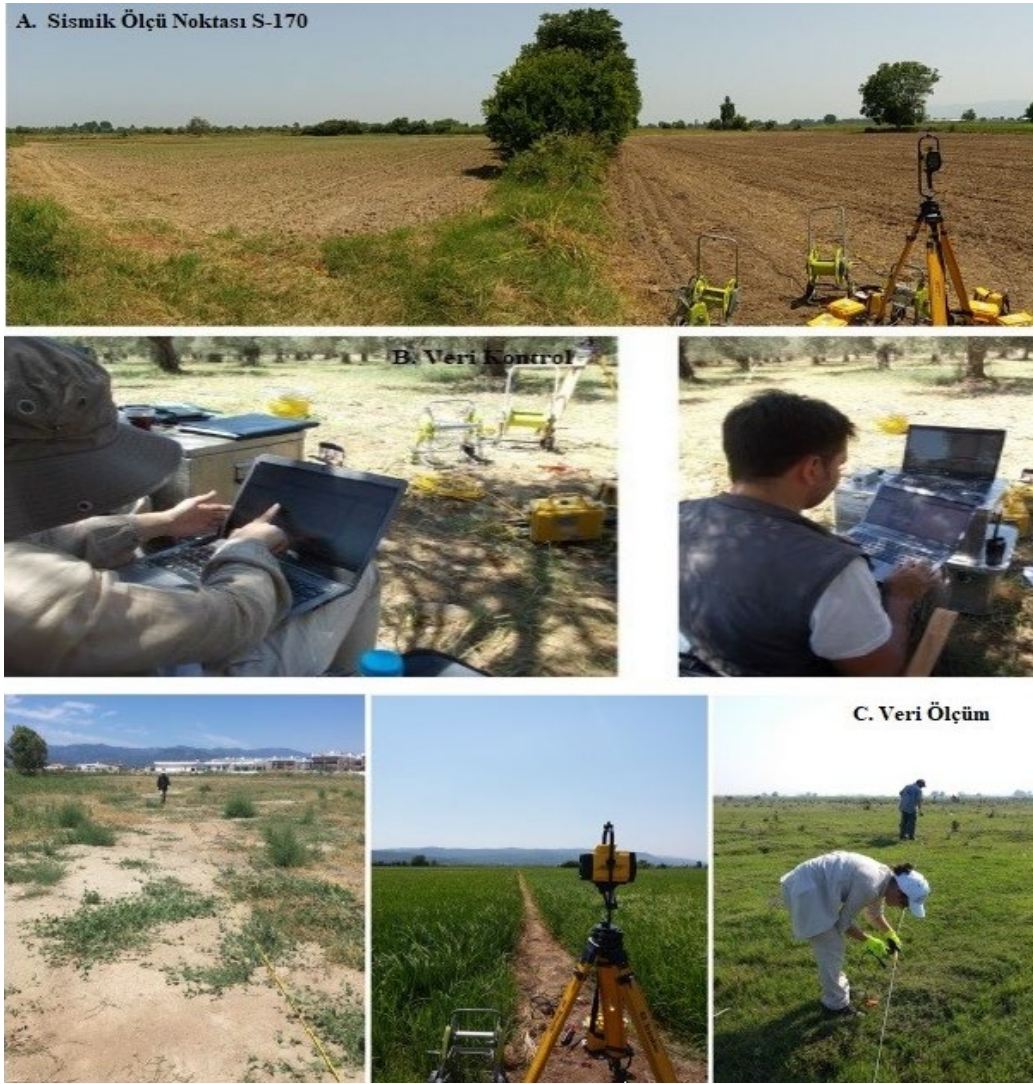
Şekil 19. MBR kapsamındaki sismik ölçümlerde profiller Nivelman(Topografik cihaz) yardımıyla A. Sismik Ölçüm Noktası S-170 oluşturulmuş ve daha sonrasında B. Veri Kontrol edilerek C. Veri ölçüm, serim, dizilim ve kayıt çalışmaları tamamlanmıştır.
