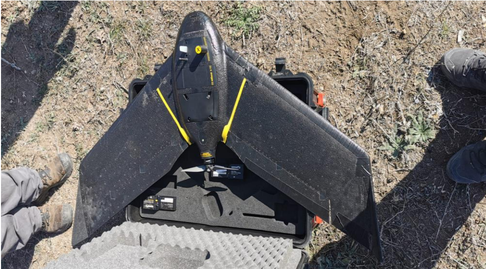
Şekil 17: Çalışmada kullanılan eBee X model İHA
