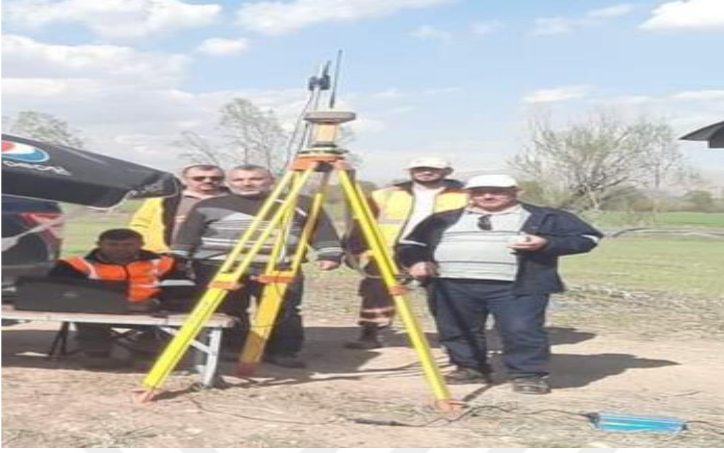
Şekil 18: Çalışma anında statik ölçüm yapan GNSS alıcısı
