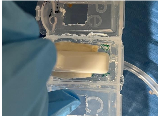
Şekil 3. 14 ve Şekil 3. 15. Kemik bloğun ve probun düzenek üzerine yerleştirilmesi
