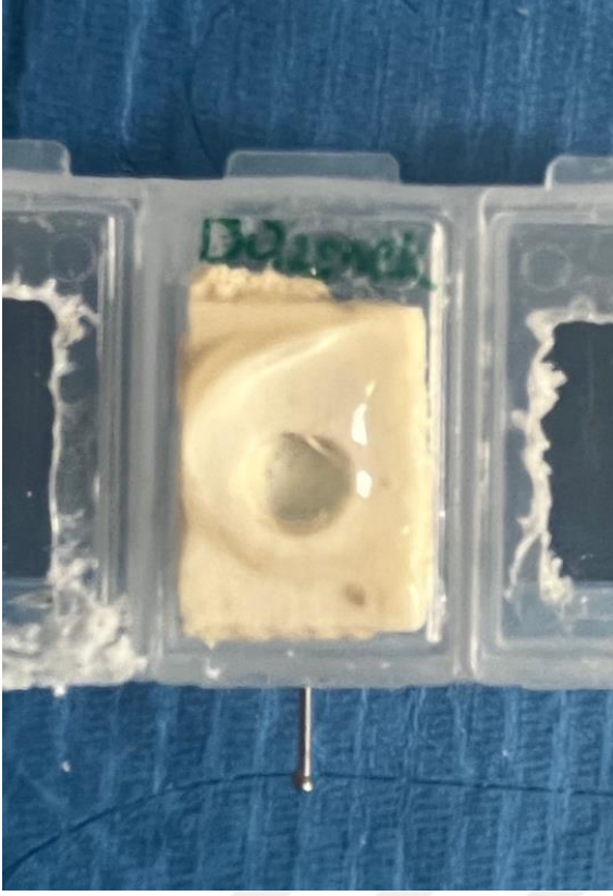
Şekil 3. 8. Kemik bloğun düzenek üzerine yerleştirilmesi ve üzerine ultrason jeli uygulanması
