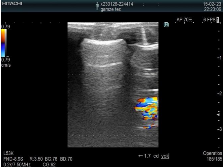
Şekil 3. 17. 1.7 mm kemik kalınlığındaki kemik bloktan USG görüntüsü, görüntü oluşumu yok
