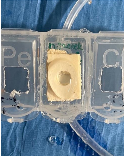
Şekil 3. 14 ve Şekil 3. 15. Kemik bloğun ve probun düzenek üzerine yerleştirilmesi
