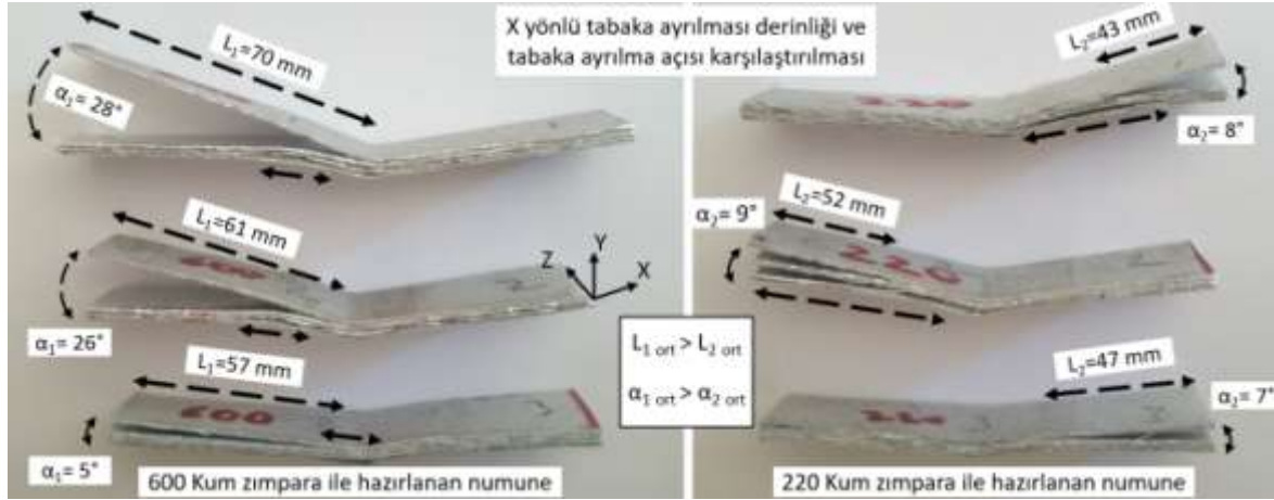
Şekil 9. 600 ve 220 kum zımpara ile hazırlanan numunelerdeki eğilme hasarı karşılaştırması.
