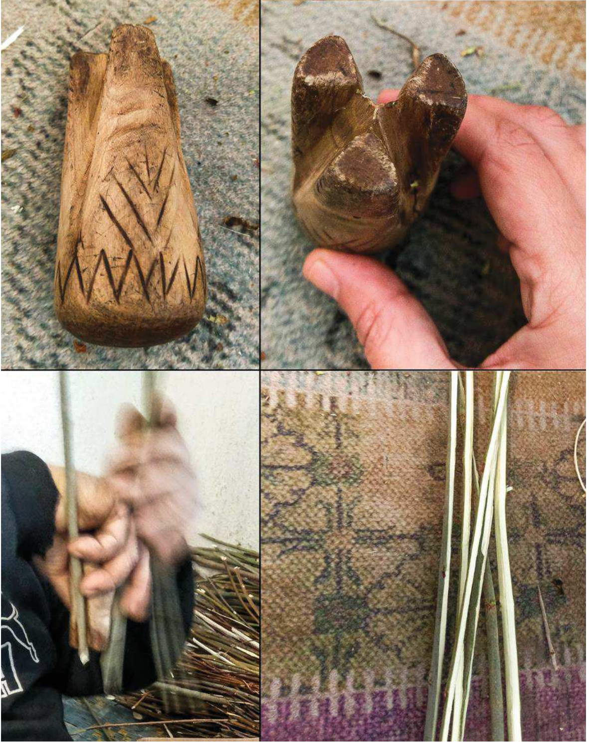
Şekil 4.39. Sepet örgü yapılacak dalların bölünmesi için kullanılan ahşap alet ve tek hamlede gerçekleşen bölme işlemi
