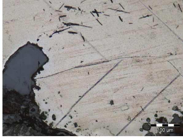
Resim 3.124. KH No.01-C'de karbonitrit iğneleri (üstte) ve Neumann bantları (altta).
