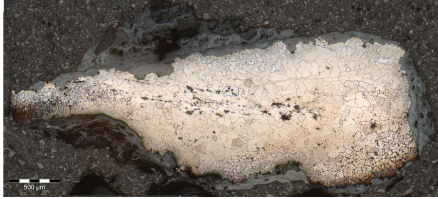
Resim 3.131. TF No.07-B dađlanma sonrası görünümü.
