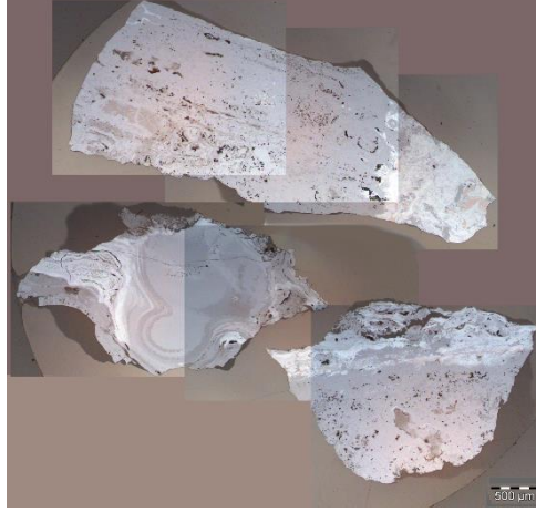
Resim 3.75. SA No.12 numunelerin korozyonlu içyapısı.
