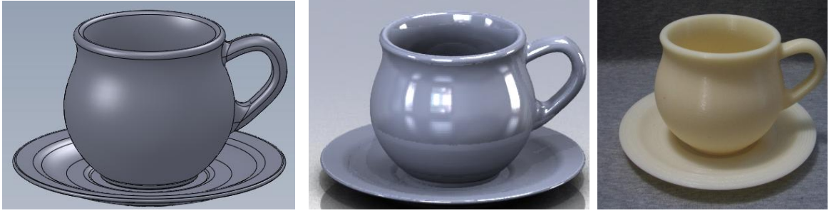
Fincan Tasarımının Çizim, Materyal Atanmış ve Prototip Görüntüsü
