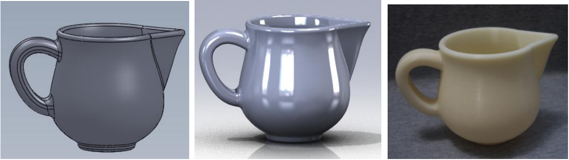
Sütlük Tasarımının Çizim, Materyal Atanmış ve Prototip Görüntüsü
