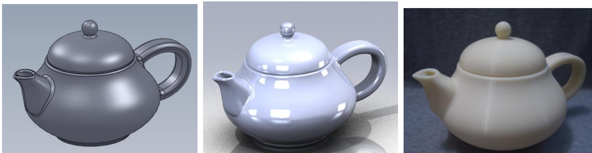
Demlik Tasarımının Çizim, Materyal Atanmış ve Prototip Görüntüsü
