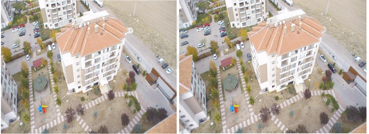
Şekil 1.20 %80 bindirme oranlı çekilmiş örtüşen RGB görüntüler
