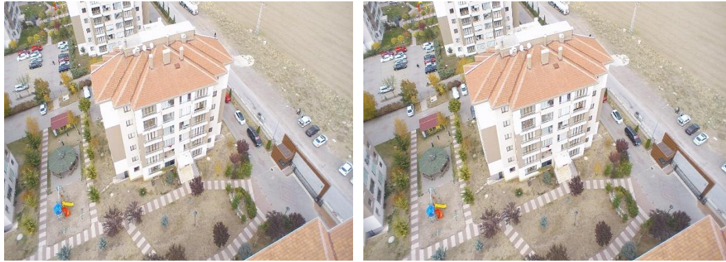
Şekil 1.15 Yuneec E10Tvx kamerası ile kazanılmış yüksek bindirmeli oblik çekilmiş RGB görüntü örneği
