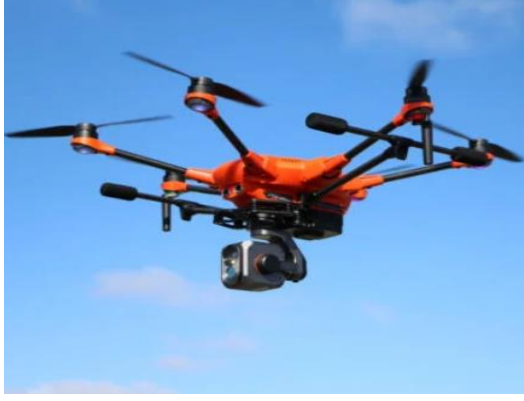
Şekil 1.6 Döner kanatlı İHA örneği (“Döner Kanatlı İHA”, 2018)
