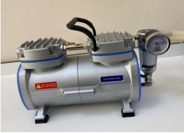
Şekil 16. Vakum pompası (30 mbar basınç)
