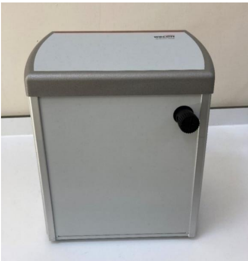
Şekil 15. Vakum pompası (10 mbar basınç)
