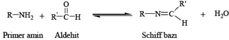
Şekil 1. Schiff bazı sentezi genel reaksiyonu
