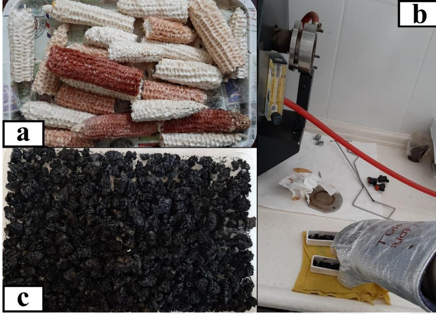
Şekil 1. a) Taneleri ayıklanmış mısır koçanları, b) Piroliz fırınından çıkartılmış krozede mısır koçanı biyokömürü c) Mısır koçanı biyokömürü
