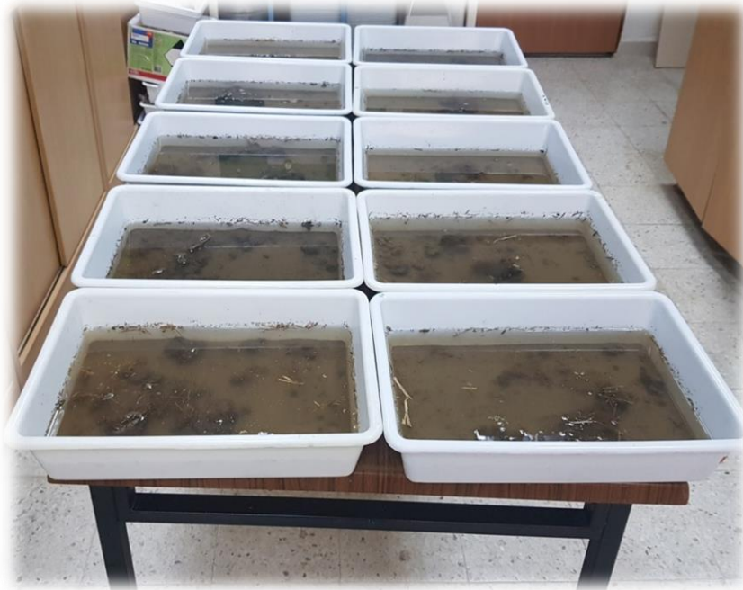
Şekil 11. Büyük taş parçaları ayıklandıktan sonra toprak örneklerinin su dolu küvetlerde yumuşatılması
