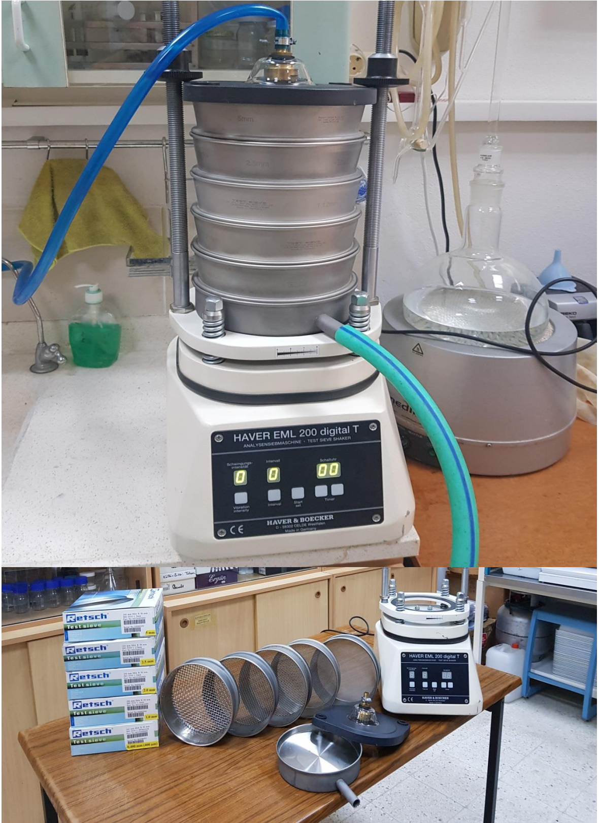
Şekil 12. Toprak örneklerini elemede kullanılan mekanik vibratör ve elek takımı
