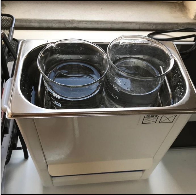
Şekil 5. ZnO nanopartiküllerinin ultrasonik banyoda sonifikasyonu.
