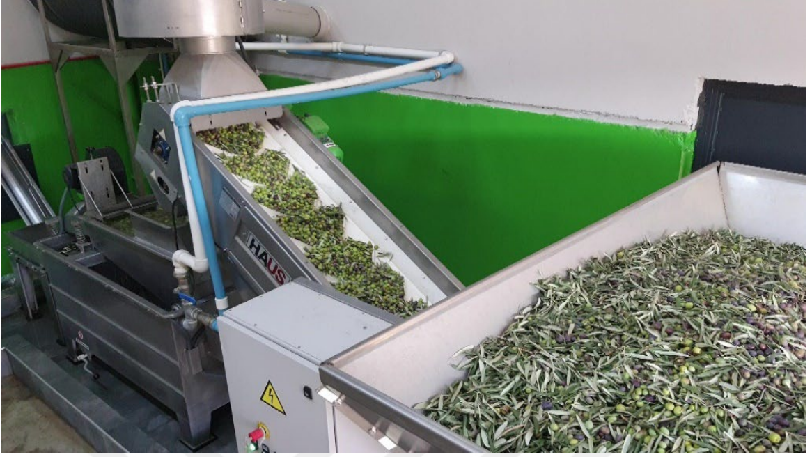
Şekil 1. Zeytin yıkama ünitesi (Adalıefe Zeytinyağı Fabrikası)
