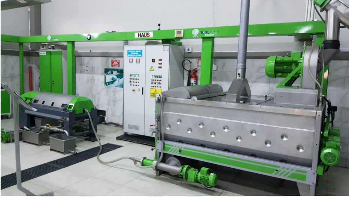
Şekil 10. Fabrikada kullanılan makinalar (soldan sağa dekantör, malaksör, kırıcı, Adalıfe Zeytinyağı Fabrikası)
