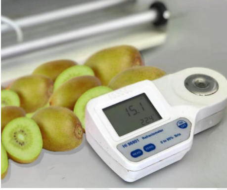
Şekil 5. Refraktometre yardımı ile suda çözünebilir kuru madde miktarı (SÇKM) ölçümü
