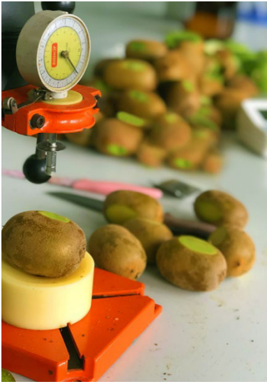
Şekil 6. Penetrometre yardımı ile meyve eti sertliği (MES) ölçümü
