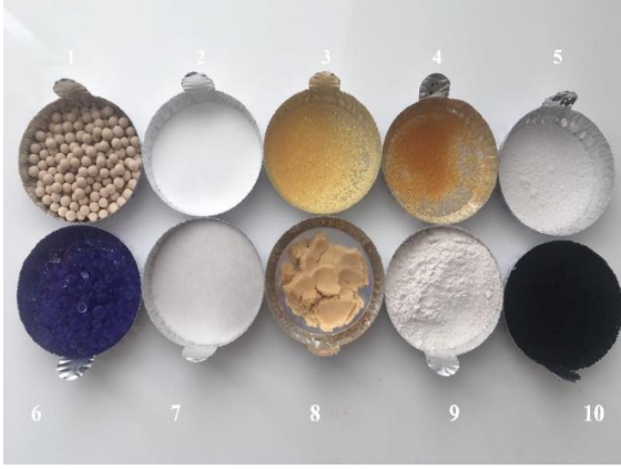
Şekil 15 Araştırmada kullanılan sentetik adsorbanlar (1. Moleküler Sieve Å, 2. Magnesol XL, 3. Amberlite IR-400, 4. Amberlite IR 120, 5. Amberlite XAD-7, 6. Silika Jel Mavi, 7. Silika Jel 60, 8. Dowex, 9. Kitin, 10. Aktif karbon)
