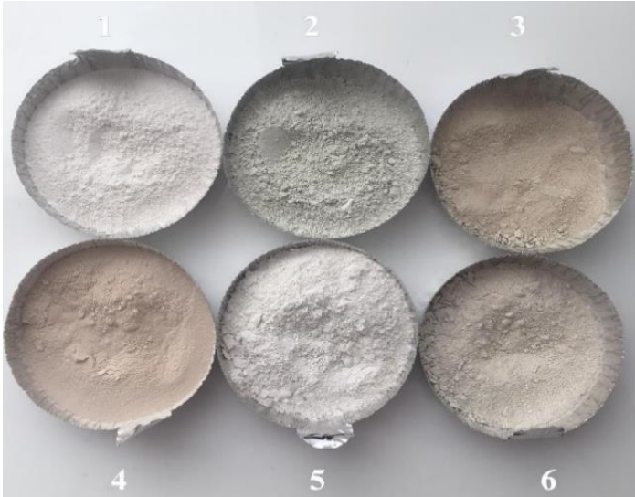
Şekil 14 Araştırmada kullanılan asitle modifiye edilmiş doğal kil adsorbanlar (1. Halloysit, 2. Zeolit, 3. Bentonit, 4. Sepiyolit, 5. Kaolin, 6. Montmorillonit)
