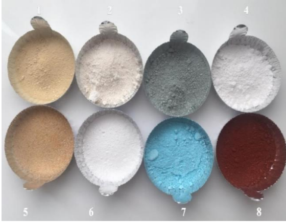
Şekil 16 Araştırmada kullanılan metal-organik çerçeve (MOF) adsorbanlar (1. Ti-MOF, 2. \gamma -CD-MOF, 3. Cr-MOF, 4. Al-MOF, 5. Zn-MOF, 6. Mg-MOF, 7. HKUST-1-MOF, 8. MIL 53-MOF)
