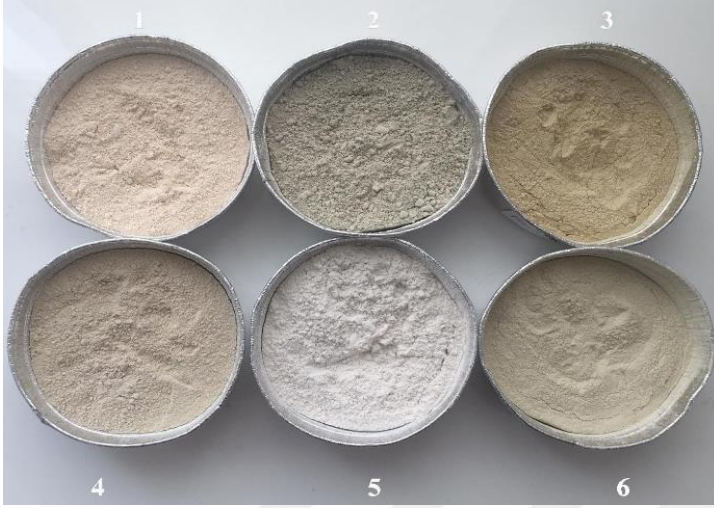
Şekil 13 Araştırmada kullanılan doğal kil adsorbanlar (1. Halloysit, 2. Zeolit, 3. Bentonit, 4. Sepiyolit, 5. Kaolin, 6. Montmorillonit)
