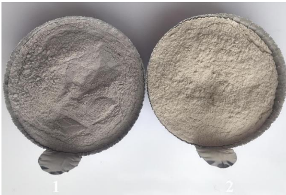
Şekil 17 Araştırmada kullanılan Kontrol Grubu adsorbanlar (1. Ticari Ağartma Toprağı I- Amcol 930, 2. Ticari Ağartma Toprağı II- Pure-Flo Supreme B81)
