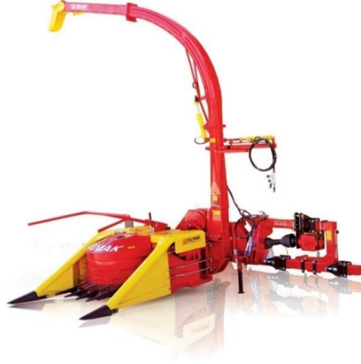
Şekil 3.6. Çift sıralı sıra bağımsız mısır ve ot silaj makinesi
