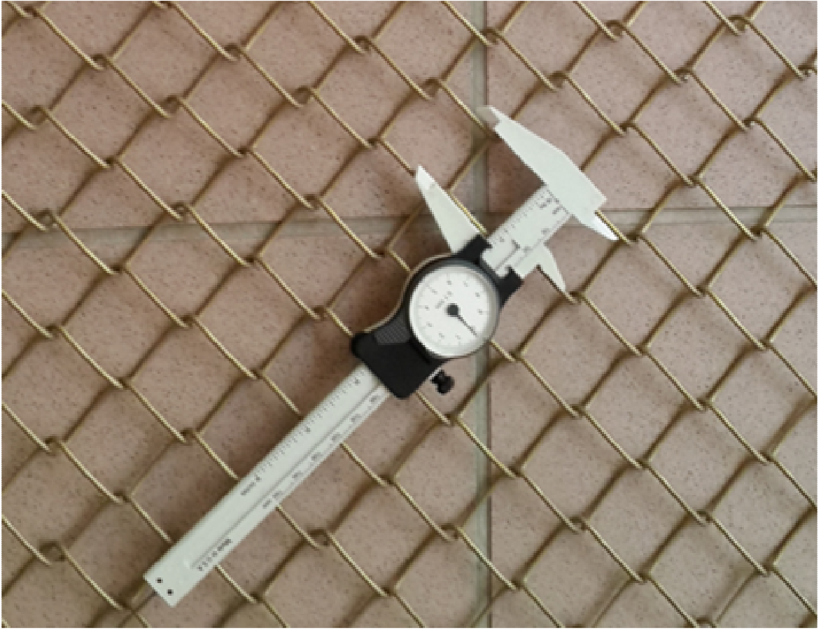
Őekil 3.8. Bakır alařım kafeste kullanılan 3 cm göz aıklığına sahip ađ malzeme
