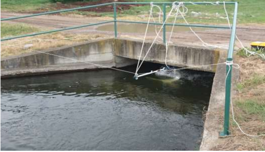
Şekil 4.17 Sulama kanalı türbin uygulama denemeleri
