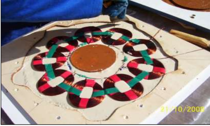
Şekil 3.7 Türbin alternatörü, stator bobinlerinin protolin kalıp içerisine alınması
