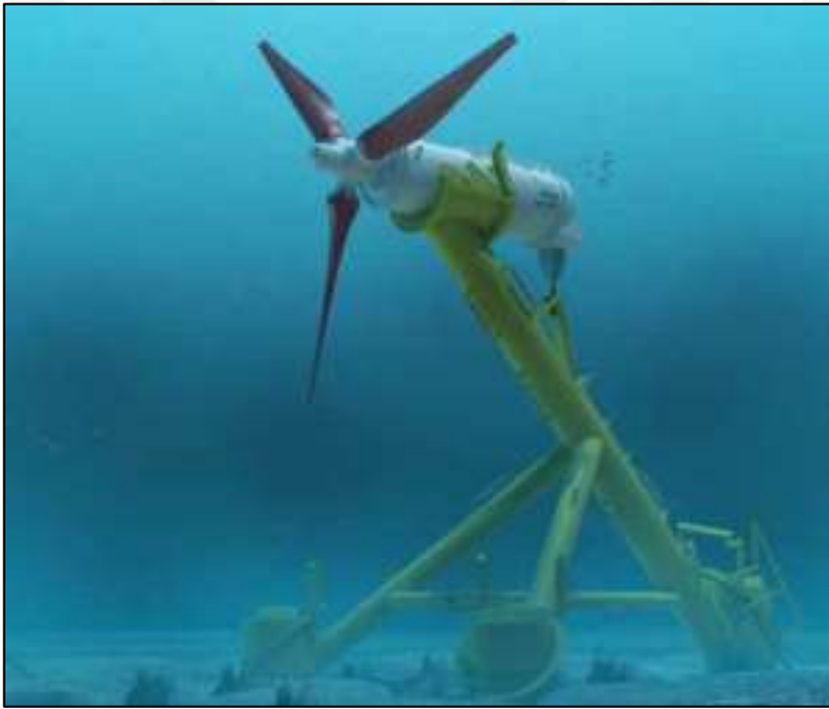
Şekil 2.2 Deniz tabanına yerleştirilmiş çift yönlü kanatlarını yönlendirebilen akıntı türbini görüntüsü (Andritzhydrohammerfest)
