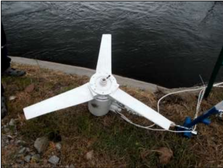
Şekil 4.3 Gönen sulama kanalı akıntı türbini uygulaması
