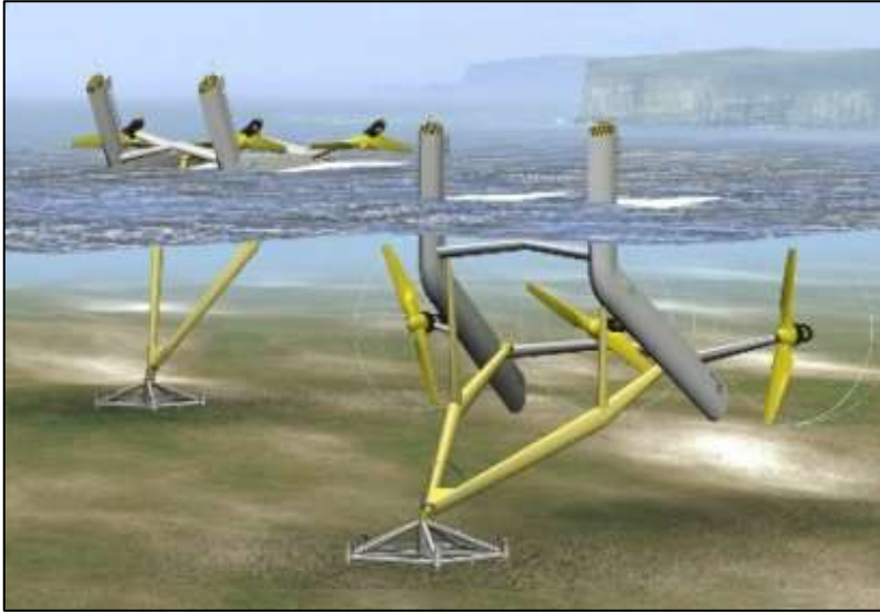
Şekil 2.4 Tidalstream firması akıntı türbini prototip uygulama çalışmaları (TidalStream Limited)
