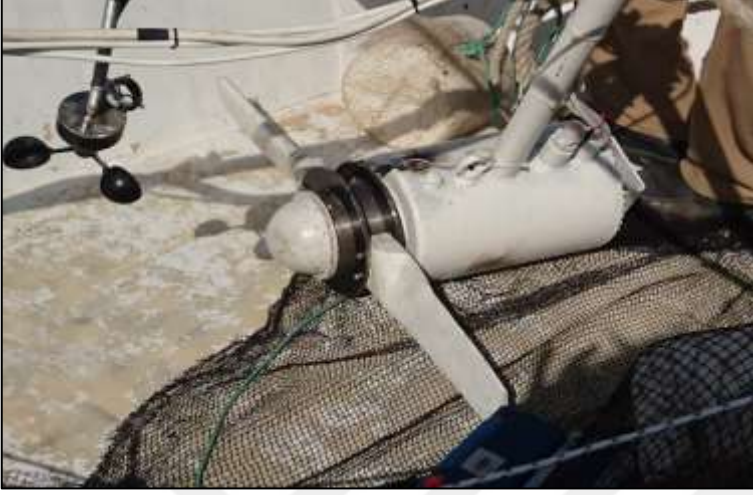
Şekil 3.9 Uygulama yapılan türbinde 38 cm uzunluğundaki kanatların rotora bağlantılarının yapılması
