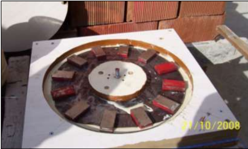
Şekil 3.8 Rotor flanşının deniz suyundan etkilenmemesi için protolin kalıp içerisine alınma uygulaması
