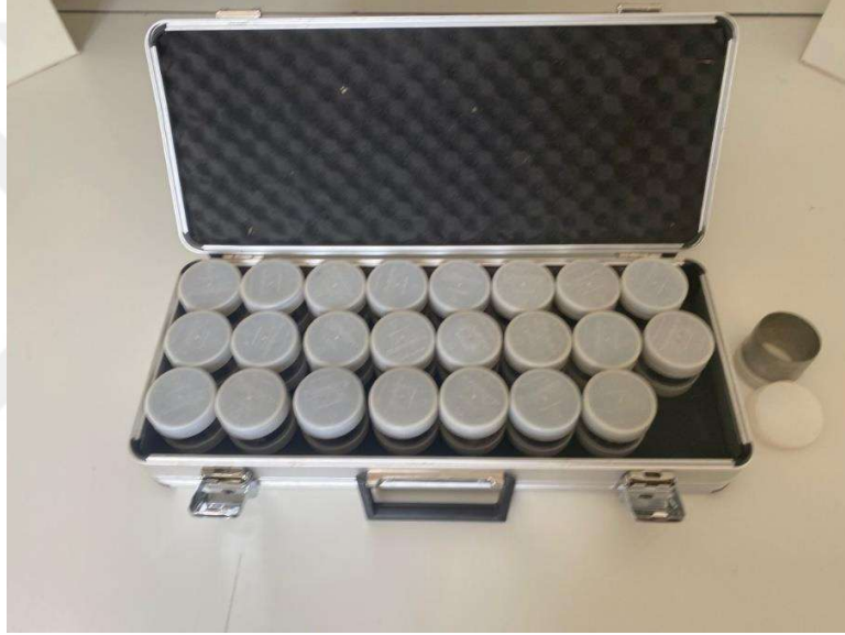
Resim 18. Bozulmamış toprak örnekleme silindirleri ve taşıma çantası (24-adet silindir seti)
