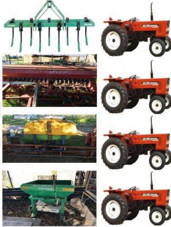
Resim 16. Azaltılmış toprak işleme- II’de kullanılan alet ve makinaların kullanım sırasına göre dizilimi
