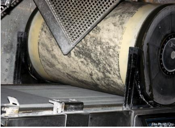
Şekil 2.Rotocolor silindirin karoya baskı işlemi
