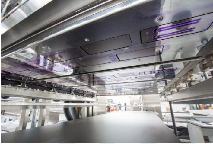
Şekil 3.Systemceramics, Creadigit dijital baskı kafalarının yerleşimi
