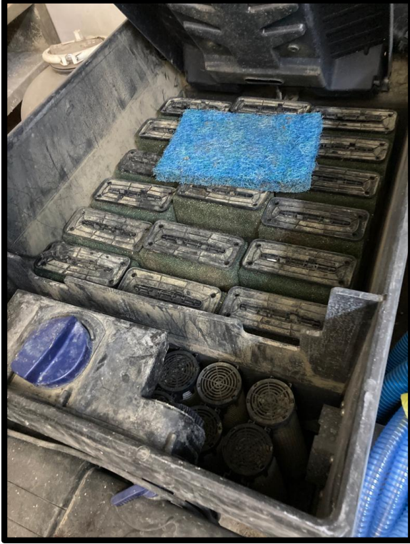
Şekil 15. Şirket D tarafından kullanılan biyolojik filtrasyon sistemi (Orijinal, 2022)
