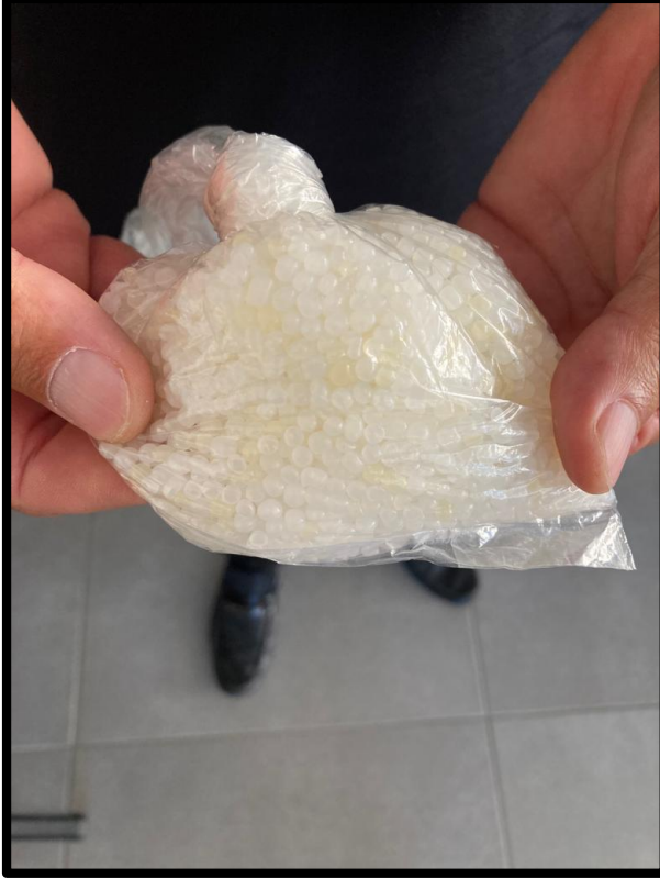
Şekil 16. Filtrasyonda kullanılan bead formundaki plastik toplar (Orijinal, 2022)
