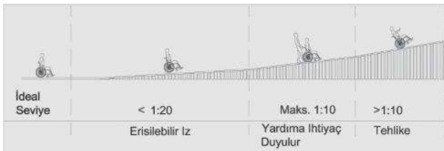
Şekil 14. Rampalarda güvenli eğim aralıkları (BM 2004, DEV 2011, Kurşun 2014).
