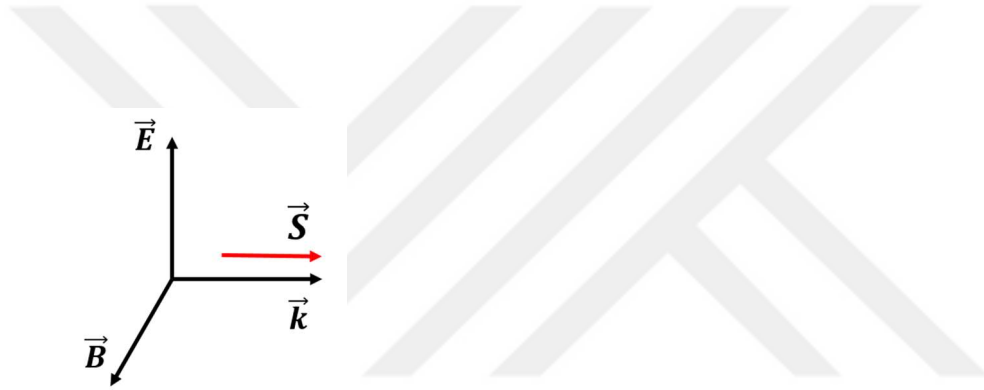
Şekil 6. Poynting vektörü ile elektromanyetik dalganın yayılma yönü.
