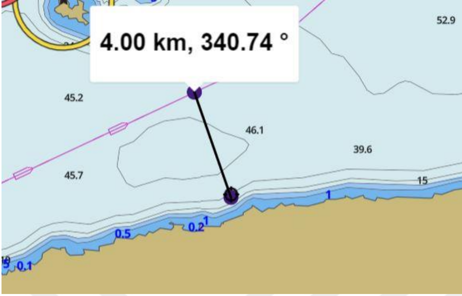
Şekil 22. Bandırma-Doğu bölgesi su derinlikleri ve en yakın gemi yoluna olan uzaklık (GPS Deniz Haritaları i-boating)
