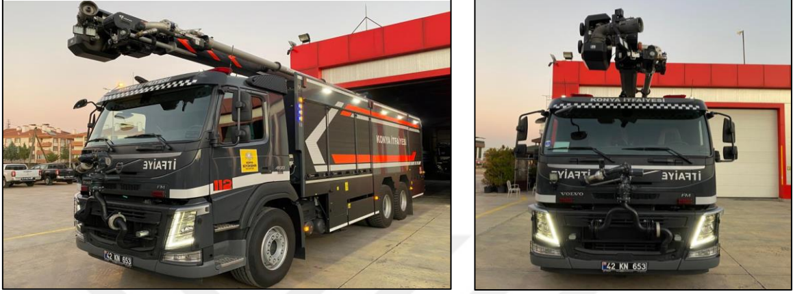
Şekil 8. Robotik kollu endüstriyel yangınlara müdahale aracı
