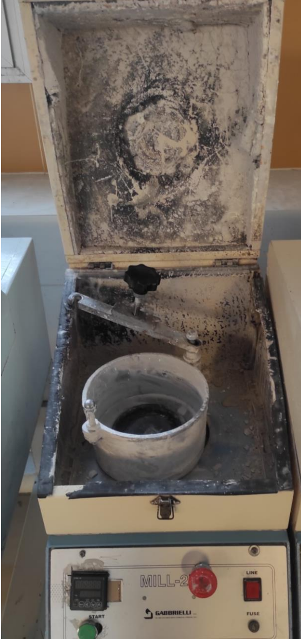
Şekil 4. Hammaddelerin karıştırma işlemlerinin yapıldığı bilyalı değirmen
