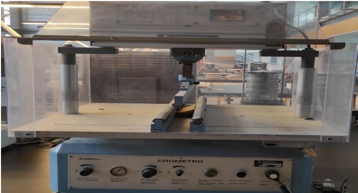
Şekil 8. Numunelerin eğilme kırılma dayanımları test düzeneęi
