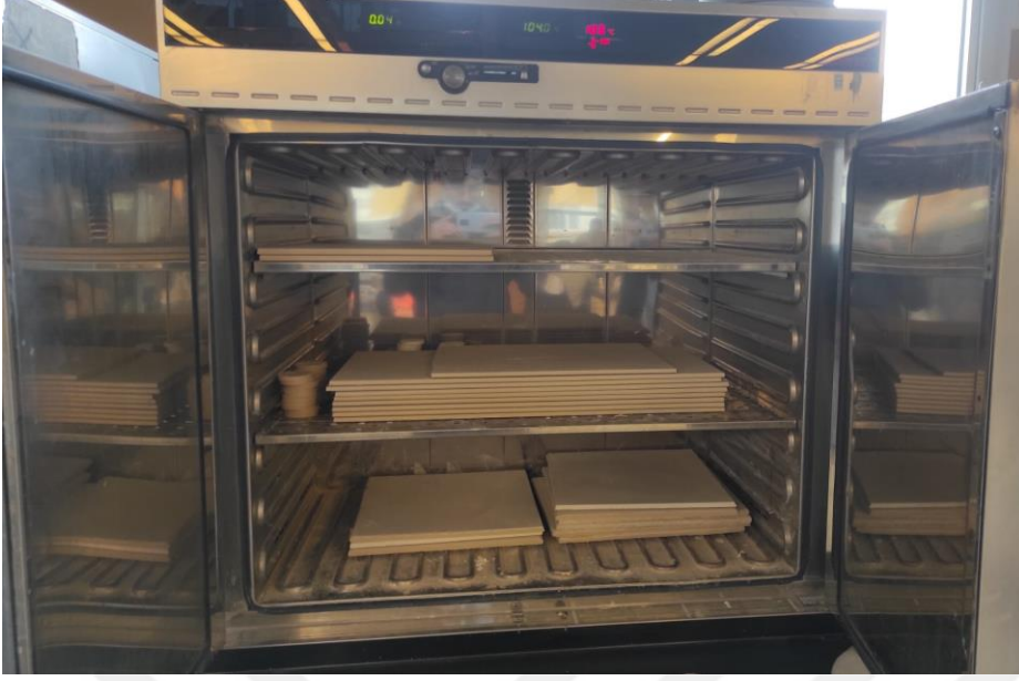
Şekil 5. Kurutma işlemlerinin gerçekleştirildiği etüv
