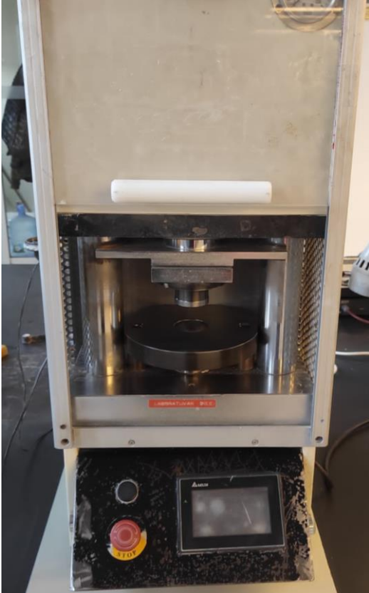
Şekil 6. Numunelerin şekillendirildiği hidrolik pres
