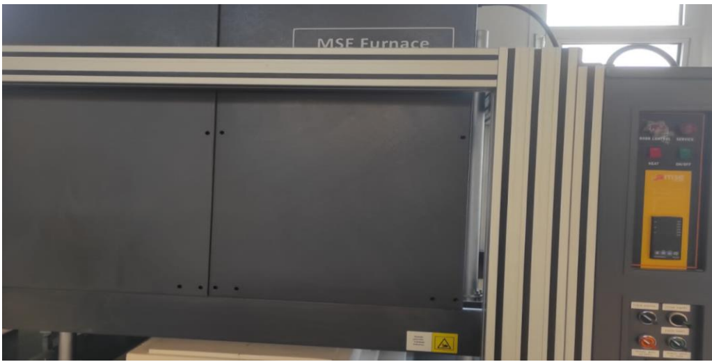
Şekil 7. Sinterleme işleminin yapıldığı fırın
