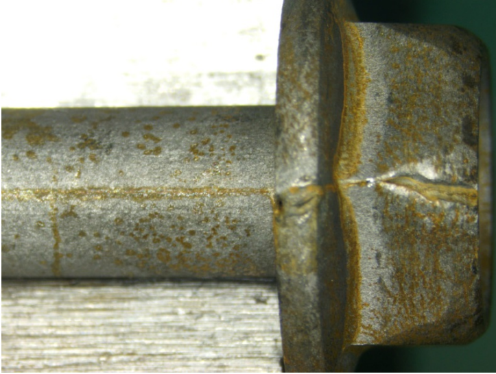
Şekil 4. Üretim esnasında oluşan gaz boşlukları
