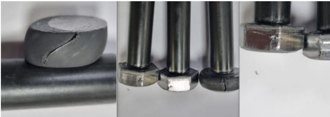
Şekil 3. Cıvata üretimi esnasında meydana gelen hatalar
