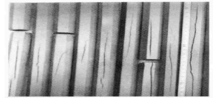
Şekil 9. Filmaşin yüzeyinde uzunlamasına oluşan çatlaklar
