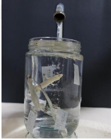
Şekil 8. Örneklerin akarsu altında bekletilme basamağı.
