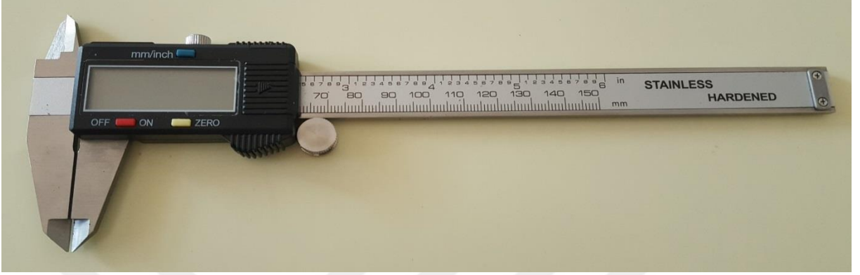
Şekil 22. Meyve ve çekirdek (en, boy) ölçümünde kullanılan 0,01 mm hassasiyetli dijital kumpas. (orj.)
