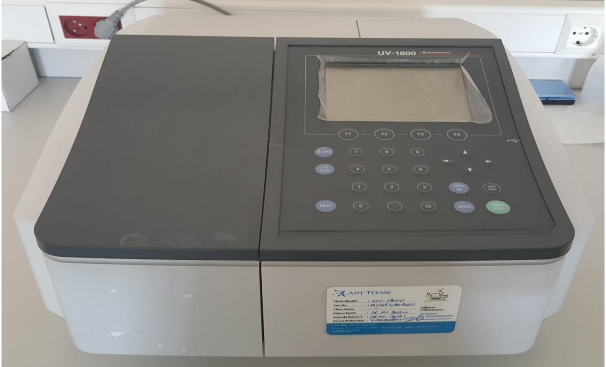
Şekil 26. Ultraviyole Özgül Absorbans ve Toplam Polifenol Miktarı değerlerinin okunmasında kullanılan Spektrofotometre. (orj.)
