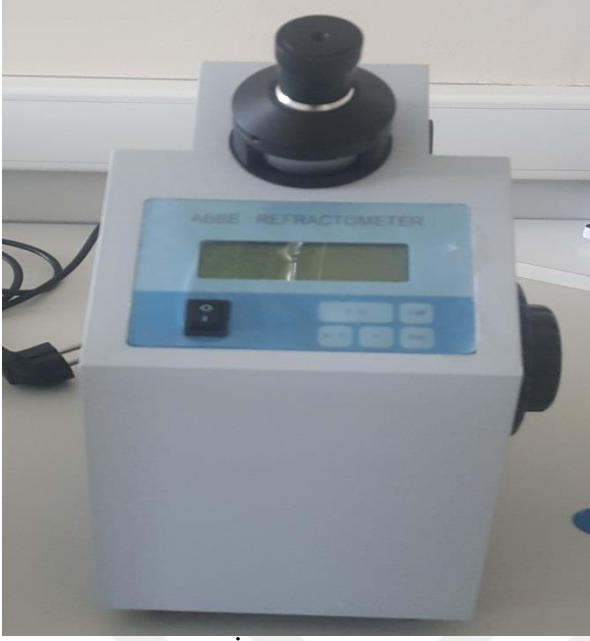
Şekil 25. Kırılma İndeksi değerlerinin okunmasında kullanılan Refraktometre (orj.)
