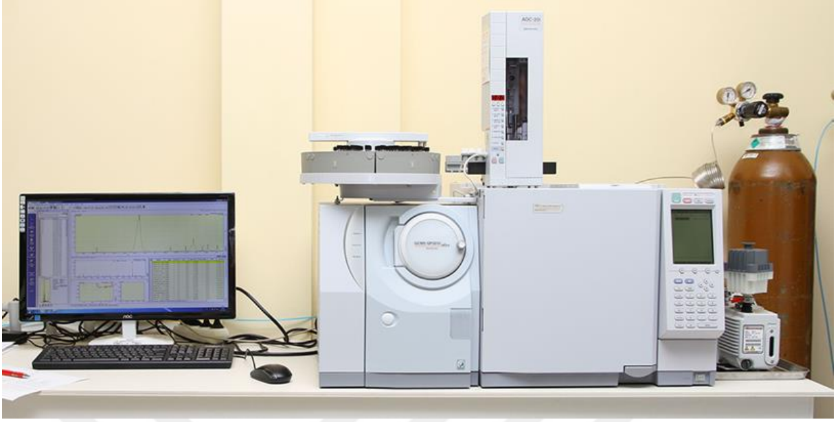
Şekil 27. Yağ Asidi Metil Esterleri Kompozisyonu analizlerinde kullanılan Gaz Kromatografisi cihazı (merlab)
