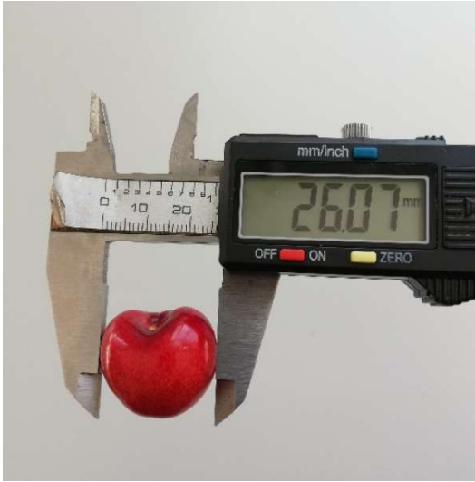
Şekil 10. Meyvenin en/boy ölçümü
